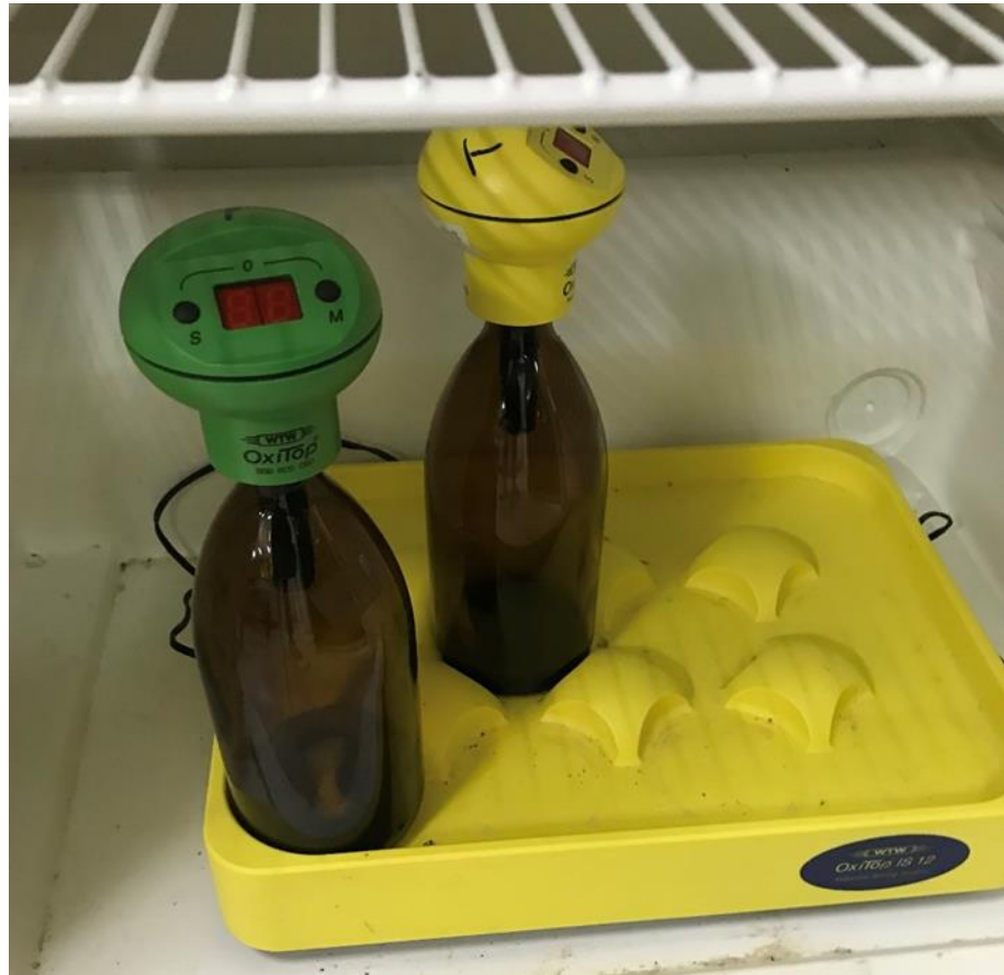
Fotoğraf 3.7: BOI 5 analizinde kullanılan düzenek
