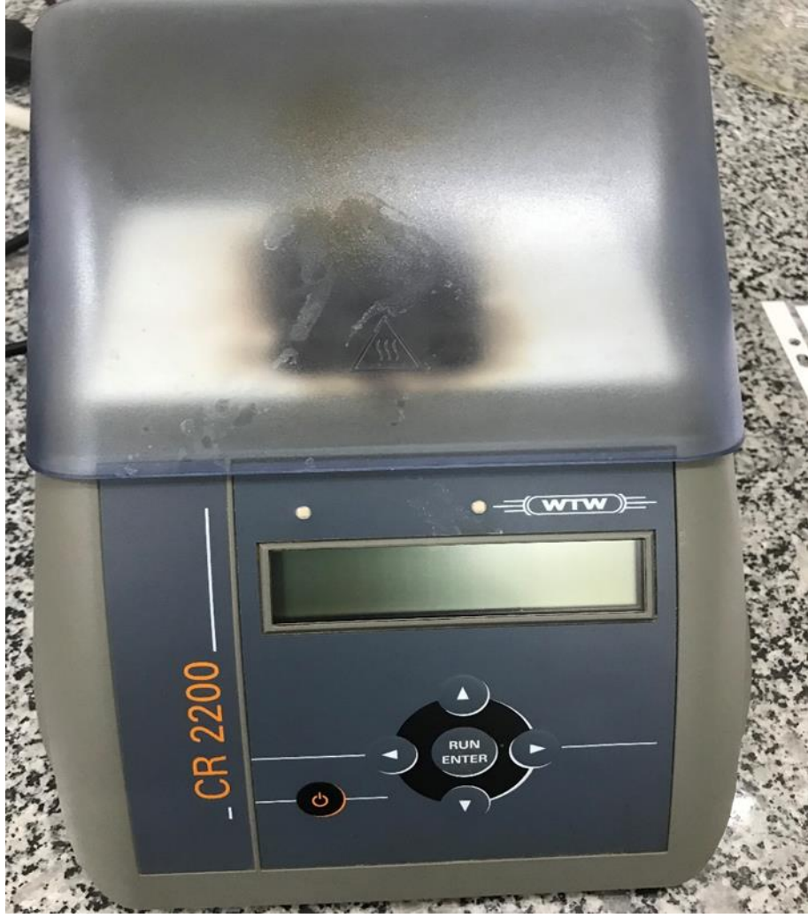
Fotoğraf 3.5: KOİ analizinde kullanılan termoreaktör
