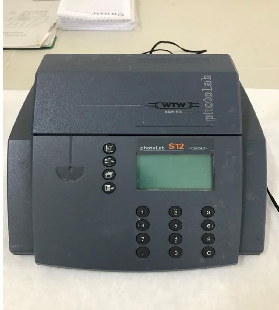
Fotoğraf 3.9: Ağır metal analizinde kullanılan fotometre cihazı
