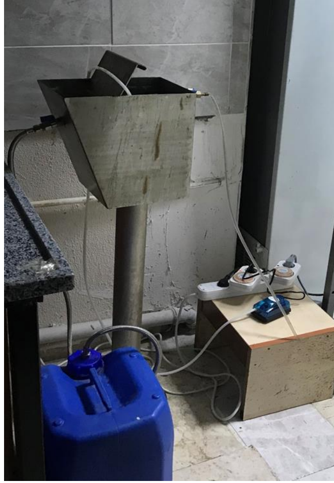
Fotoğraf 3.2: Çalışmada kullanılan CSTR reaktör
