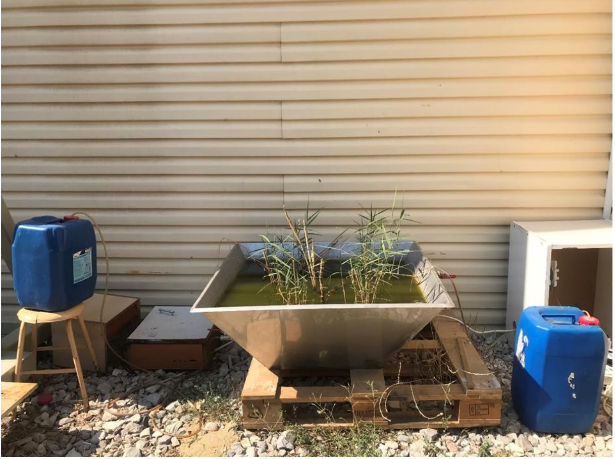
Fotoğraf 3.4: Çalışmada kullanılan pilot ölçekli doğal arıtma reaktörü
