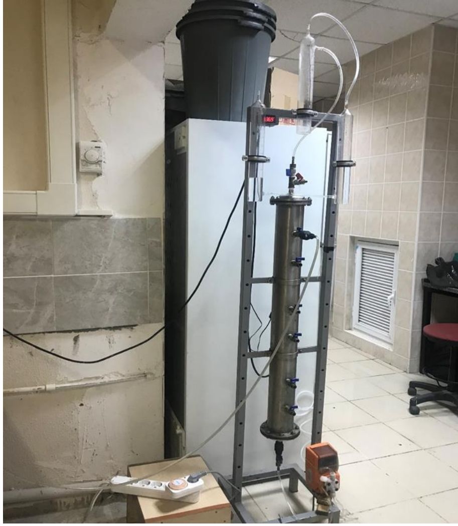
Fotoğraf 3.1: Çalışmada kullanılan YAÇY reaktör
