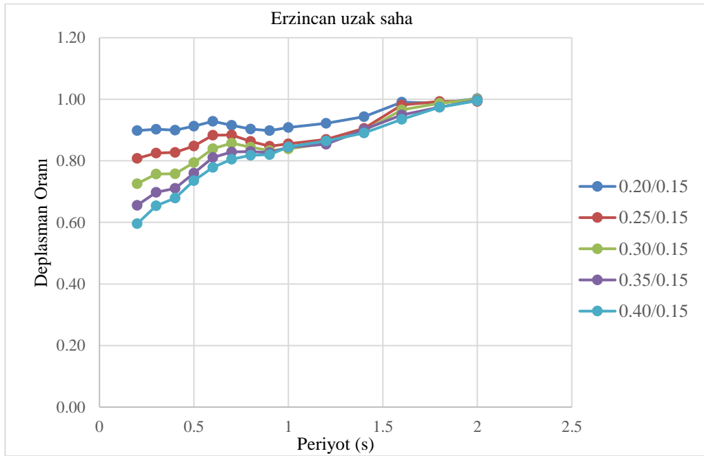
Şkil 5. 19: Erzincan uzak saha deprem kayıtları için dayanım artışının deplasman talepleri üzerindeki göreceli etkisi
