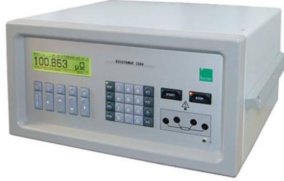
Şekil 4.3.1: Direnç Ölçüm Cihazı (RESISTOMAT® 2304) (Burster 2022)
