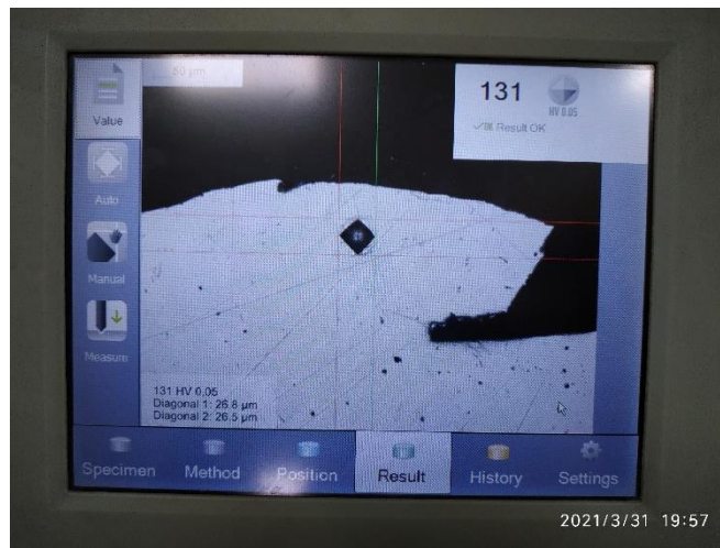
Şekil 4.5.8: Emtotest DuraScan mikro sertlik ölçüm cihazı ile yapılan örnek sertlik ölçümü
