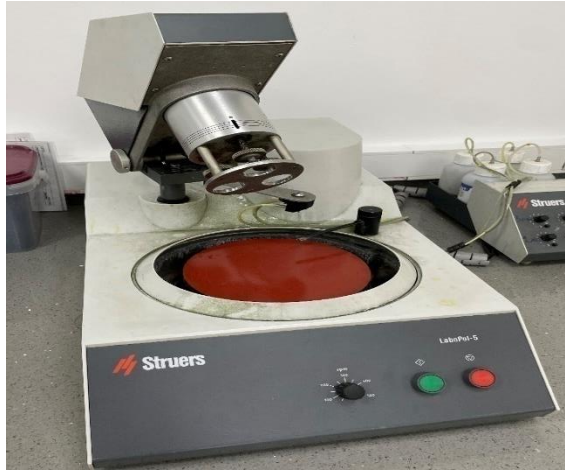
Şekil 4.7.6: Struers Labapol-5 Zımpara ve Parlatma Makinesi
