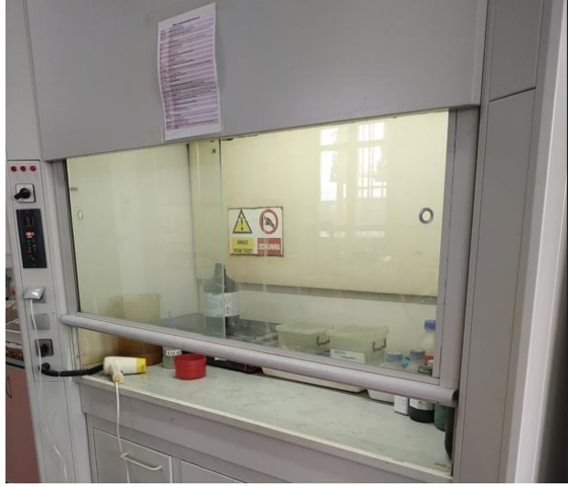
Şekil 4.7.7: Dağlamanın Yapıldığı Çeker Ocak (Er-Bakır)
