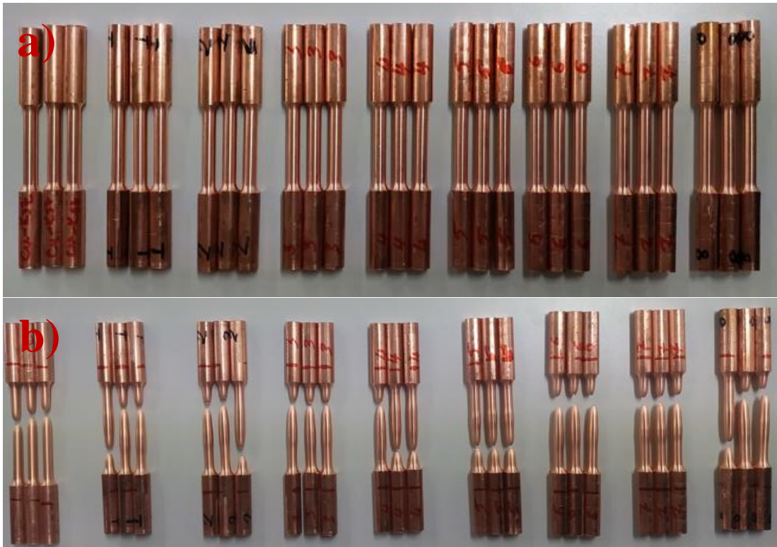
Şekil 5.4.1: Çekme numunelerinin a) Çekme deneyi öncesindeki görüntüsü, b) Çekme deneyi yapıldıktan sonraki görüntüsü ve kopma noktaları
