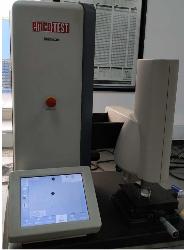
Şekil 4.5.7: Emtotest DuraScan mikro sertlik ölçüm cihazı
