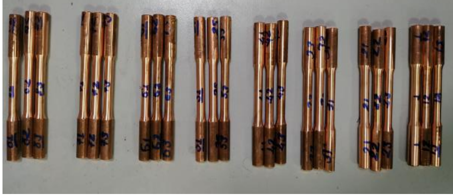
Şekil 4.6.4: Çekme Testi Deney Numuneleri
