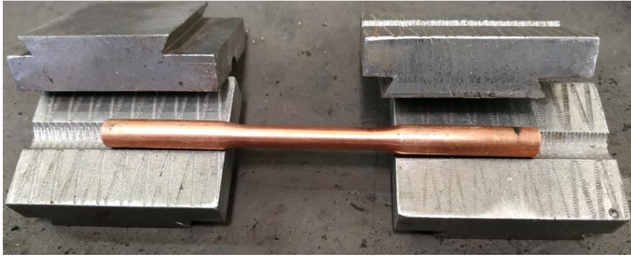
Şekil 4.6.5: Çekme Testi Deney Numunesi ve Test Çenesi
