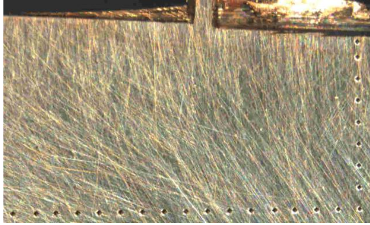
Şekil 4.5.11: Sıcak kalıba alınmış ve mikro sertlik ölçümü yapılmış numune örneği-1X
