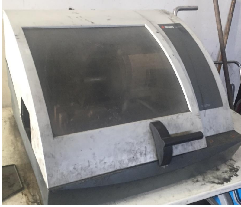
Şekil 4.7.1: Struers CitoPress-1 Kaba Kesme Makinesi
