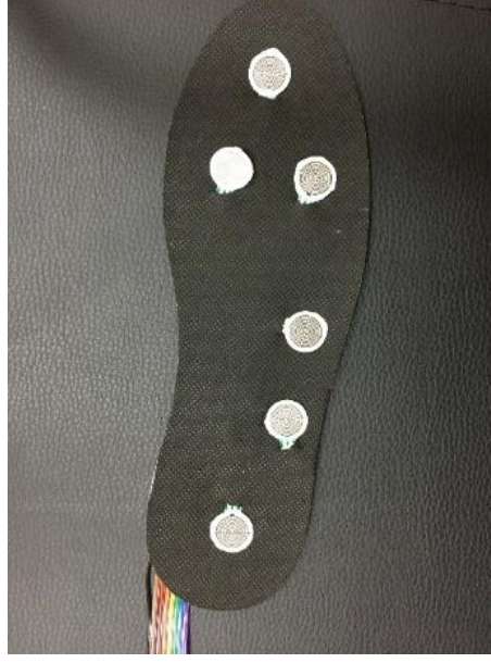
Şekil 3.6: Kuvvet algılama direnç sensörü ile taban tasarımı.
