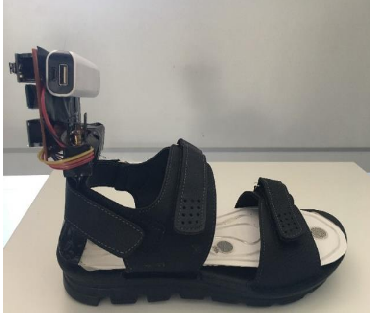
Şekil 3.5: Tasarımı gerçekleştirilen tabanın ve kontrol sisteminin sandalete yerleştirilmesi.
