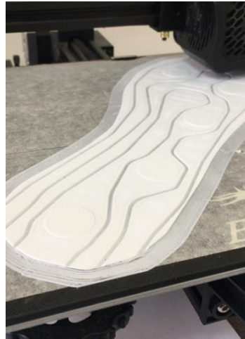
Şekil 3.2: Ayakkabı tabanının 3D Yazıcı ile üretilme aşaması.
