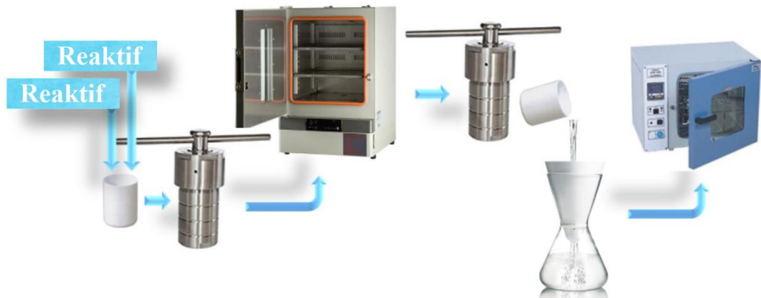
Şekil 3.4: Solvotermal yöntem şematik gösterimi (Öztürk 2015)
