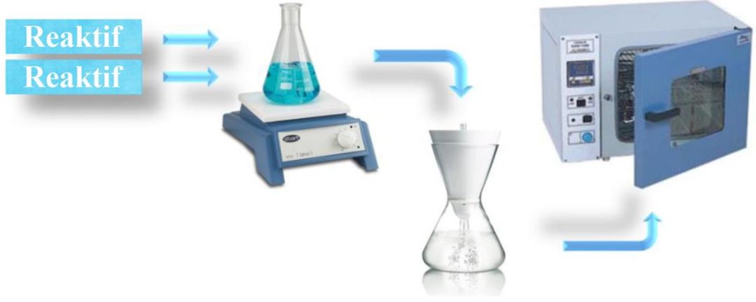
Şekil 3.3: Oda koşulları sentez yöntemi şematik gösterimi (Öztürk 2015)
