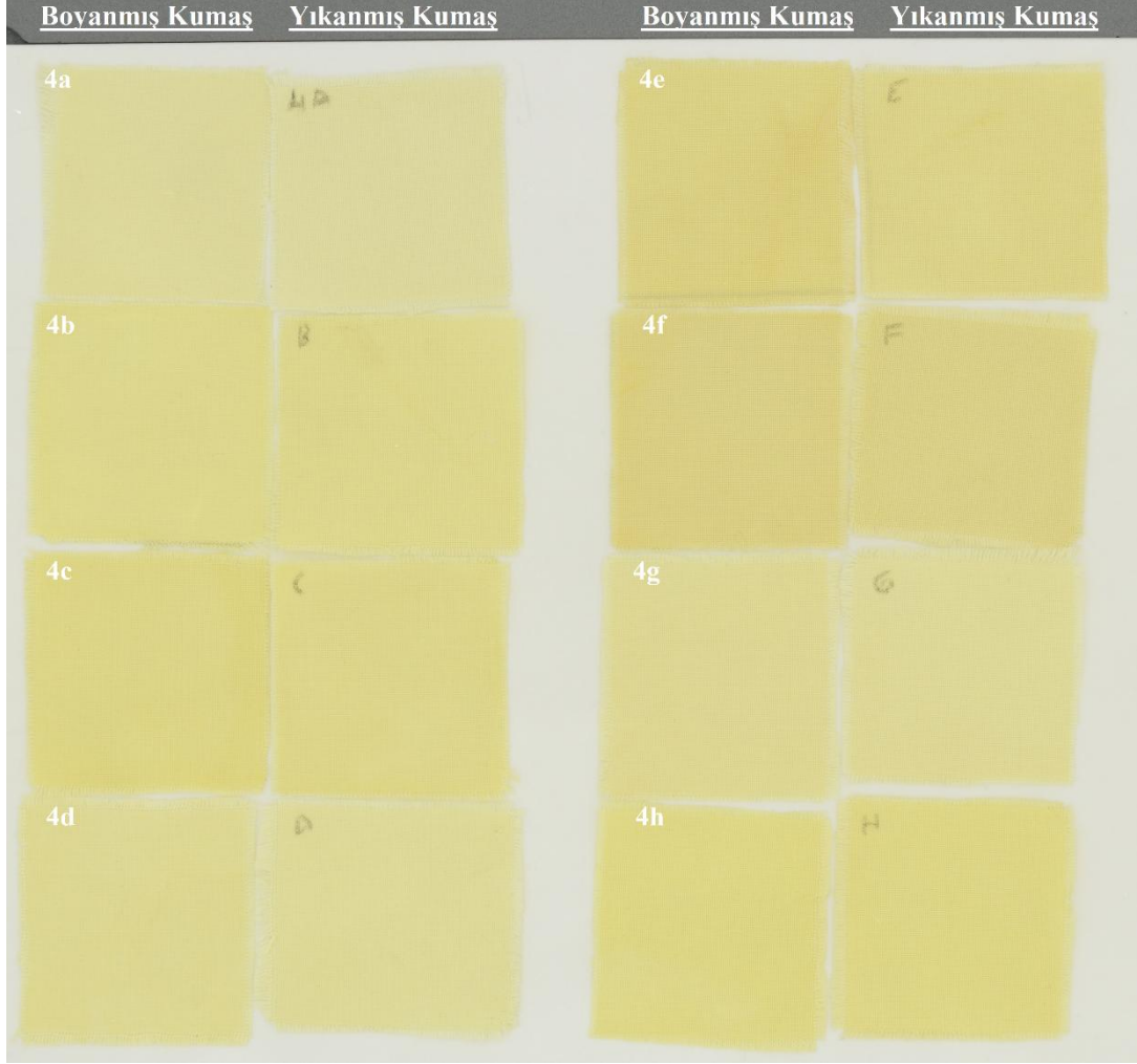
Şekil 4.43: 4a-h Bileşiklerinin yıkama sonrası renk değişimleri
