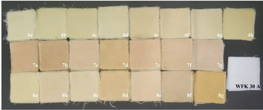
Şekil 4.35: 4a-h, 7a-g ve 8a-g bileşikleriyle boyanmış ve boyanmamış PET kumaşların görüntüsü
