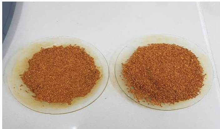
Şekil 2.3: Modifikasyon işlemleri sonucu elde edilen FeZ materyali.
