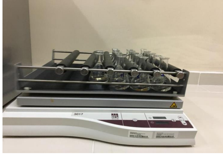
Şekil 2.6: Çalkalayıcı kullanılarak gerçekleştirilen kesikli adsorpsiyon deney düzeneği.
