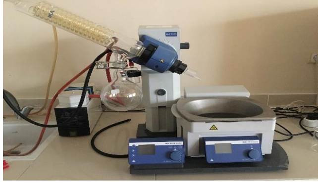
Şekil 2.5: Evaporatör kullanılarak gerçekleştirilen buharlaştırma işlemi.
