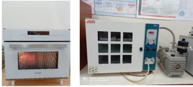
Şekil 2.4: Sıcak hava-mikrodalga hibrit fırını (solda) ve vakumlu etüv (sağda)
