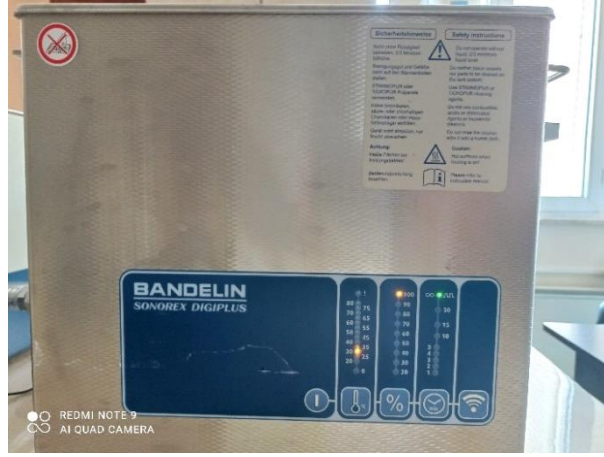
Şekil 2.6: Ultrases ön işlemlerinde kullanılan ultrasonik su banyosu
