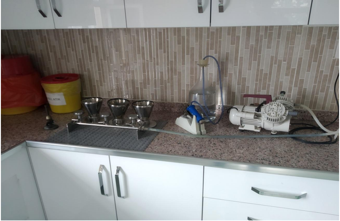
Şekil 3.1 Sağlık Bakanlığı Halk Sağlığı Laboratuvarı ve üçlü vakum pompalı filtrasyon cihazı
