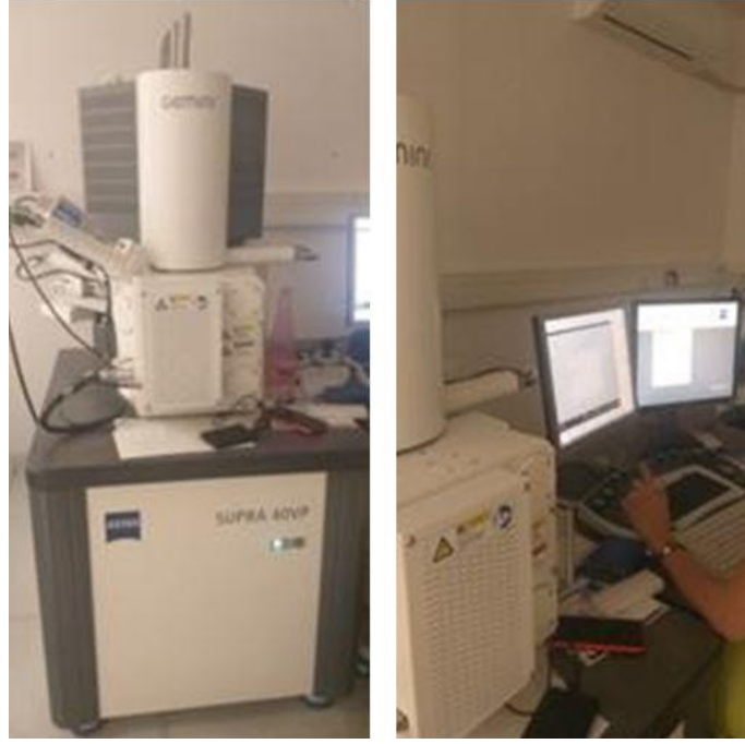
Şekil 4. 18: Deneyde kullanılan taramalı elektron mikroskobu (SEM)
