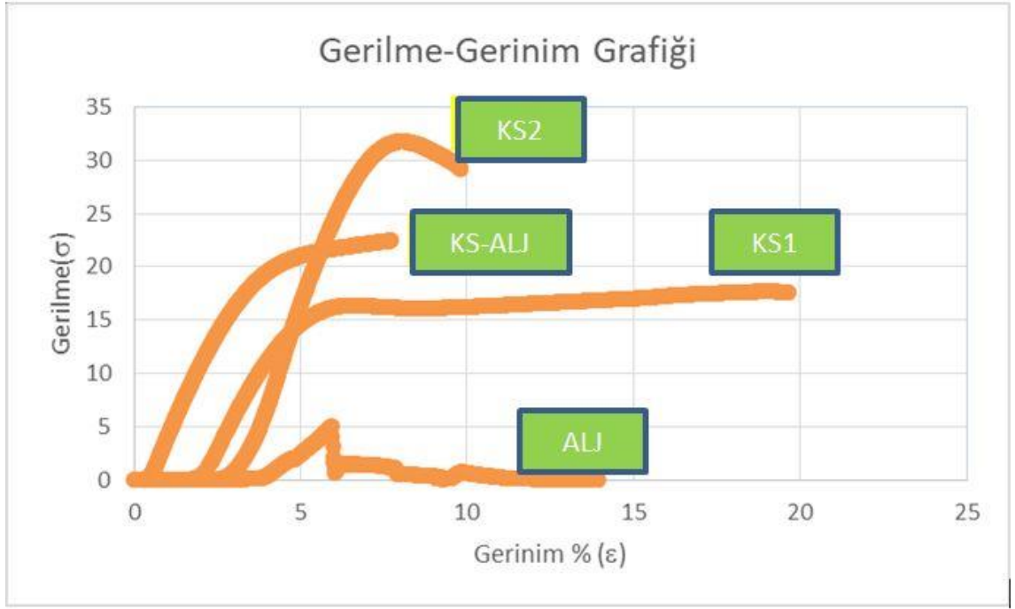
Şekil 5. 6: Numunelerin mekanik test değerlerinin karşılaştırılması
