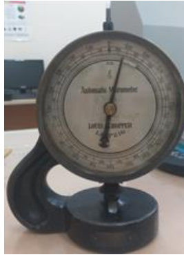
Şekil 4. 12: Deneyde kullanılan Automatic mikrometre
