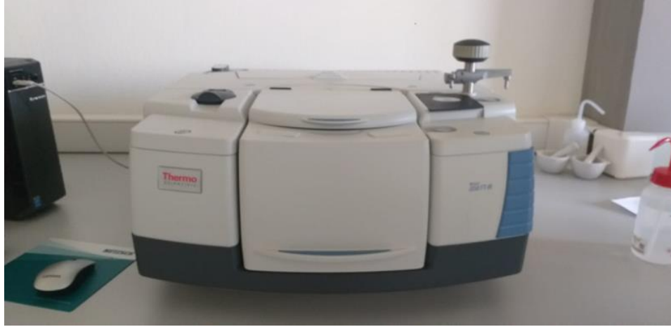
Şekil 4. 24: Deneyde kullanılan FT-IR cihazı
