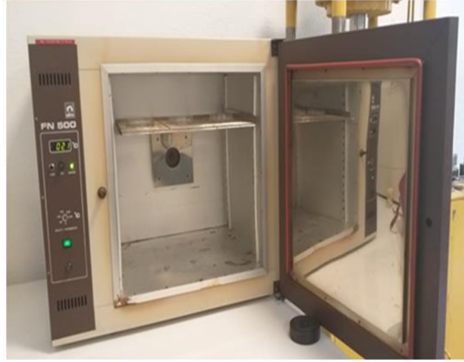
Şekil 4. 13: Deneyde kullanılan Nüve FN 500 marka etüv fırın
