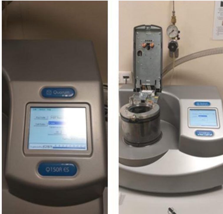
Şekil 4. 17: Paladyum kaplama cihazı
