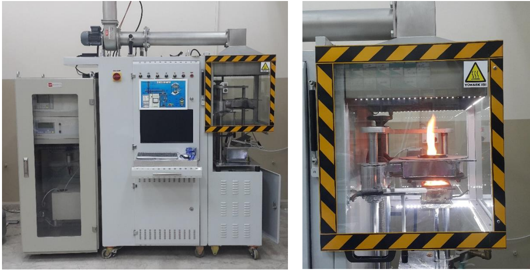
Şekil 3.25: Konik kalorimetre test cihazı
