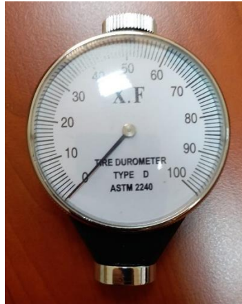
Şekil 3.36: Shore D sertlik deneyi cihazı
