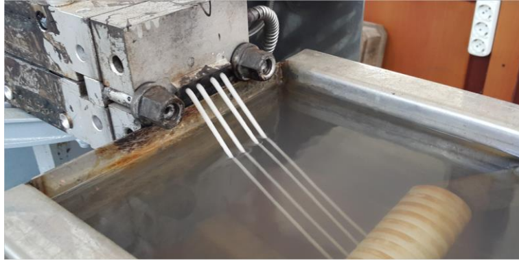
Şekil 3.15: Ekstrüderden kompozit malzeme çıkışı
