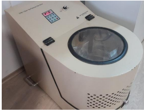
Şekil 3.10: Planet sistemli bilyalı öğütücü
