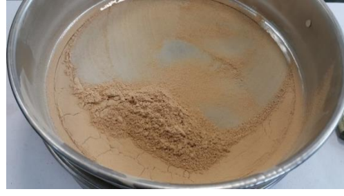
Şekil 3.12: Planet sistemli öğütücü sonrası 45 µm elekten elenmiş ceviz kabuğu tozu
