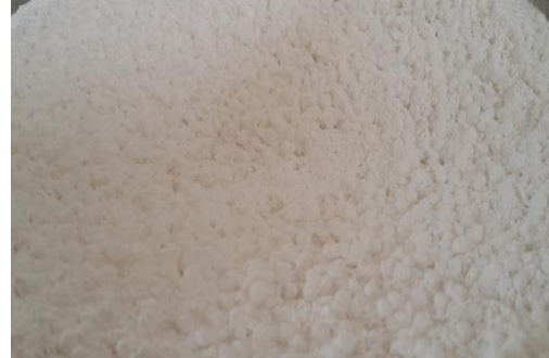
Şekil 3.13: Ekstrüzyon öncesi granül ve toz maddelerin karışımı
