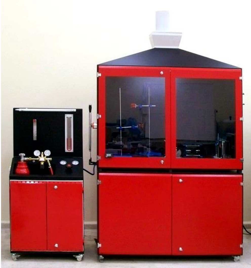
Şekil 3.21: UL 94 yanma test cihazı
