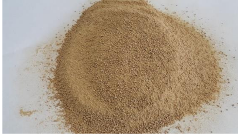
Şekil 3.11: Planet sistemli öğütücü sonrası ceviz kabuğu tozu
