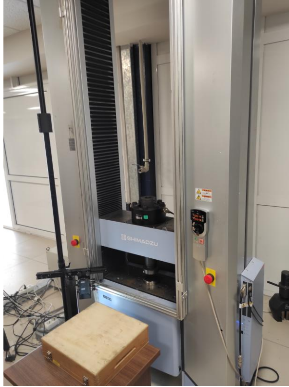
Şekil 3.2: Shimadzu AG-X geleneksel test cihazı
