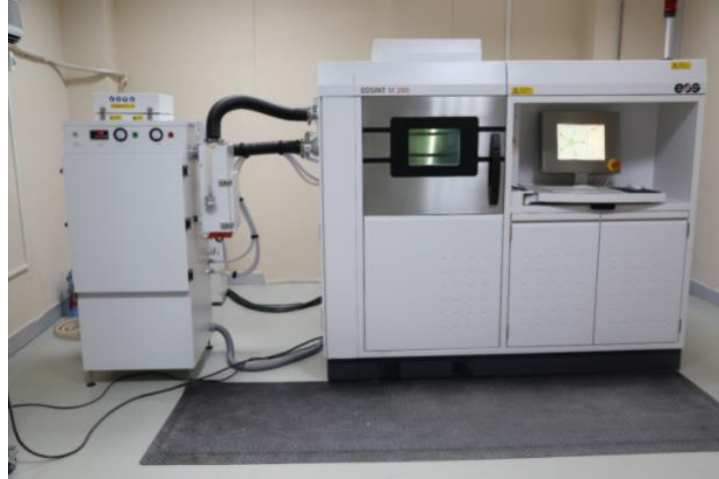
Şekil 5.1: EOSINT M280 DMLS cihazı
