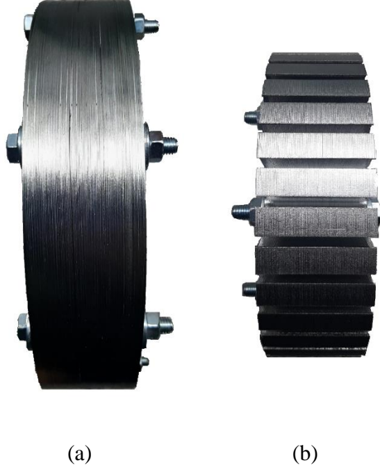
Şekil 5.1: Sacların paketlenip vidalanmasıyla oluşan a) Rotor ve b) Stator.
