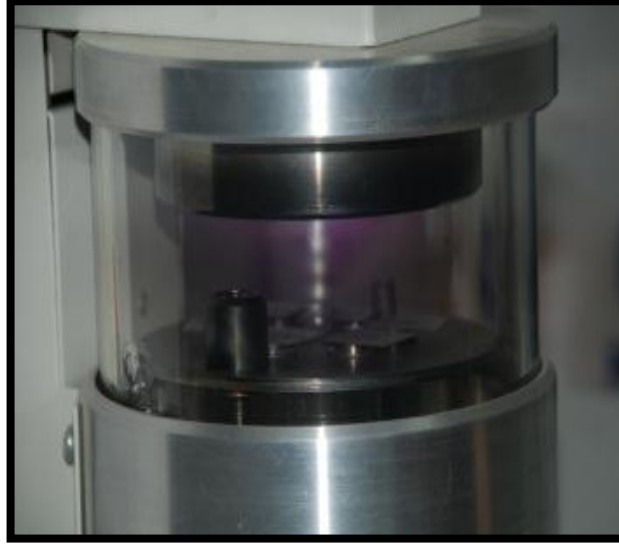
Şekil 2.20: Alg örneklerinin altın-paladyum ile kaplama işlemi
