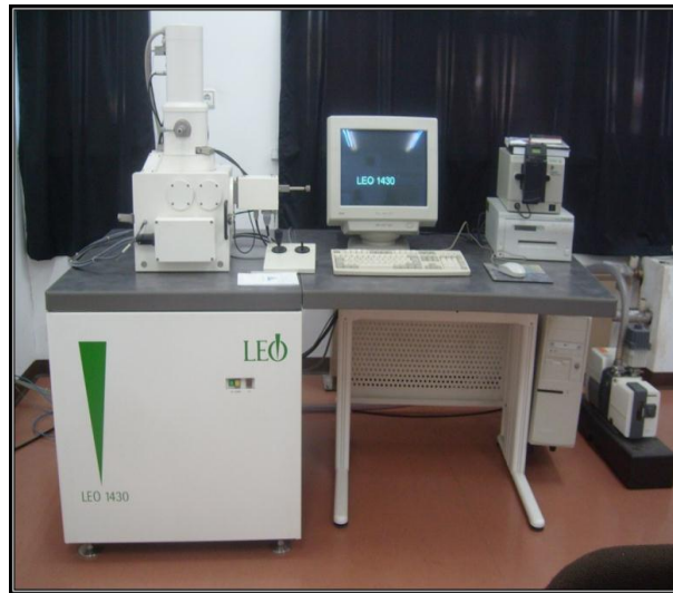
Şekil 2.21: Çekim yapılan elektron mikroskobunun görüntüsü
