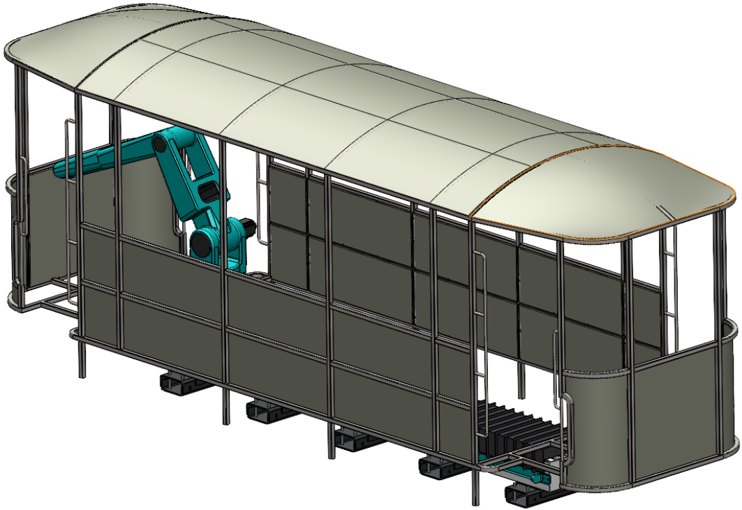
Şekil 3.6: Robot kolun ikinci referans noktasındaki konumu.
