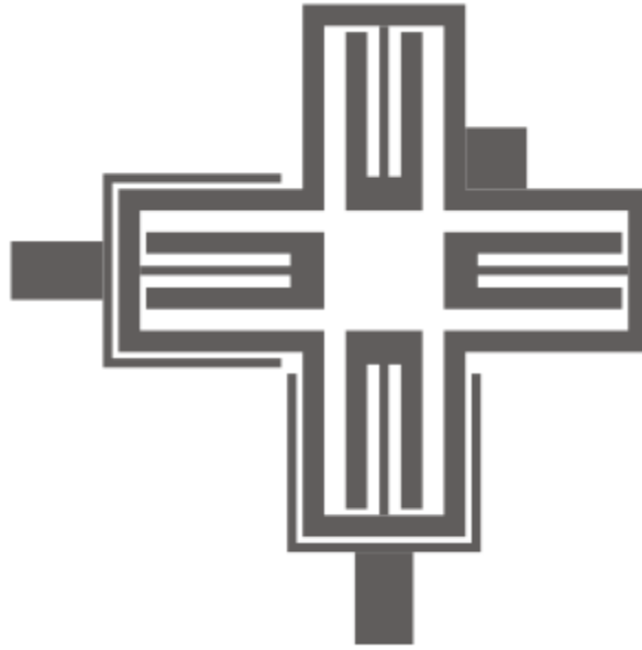
Şekil 1.12: Açık devre sonlandırmalı yan hatlara sahip çift mod bant geçiren filtre.
