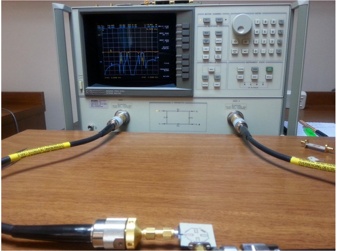
Şekil 5.5: Network Analyzer ile yapılan ölçüm sonucu
