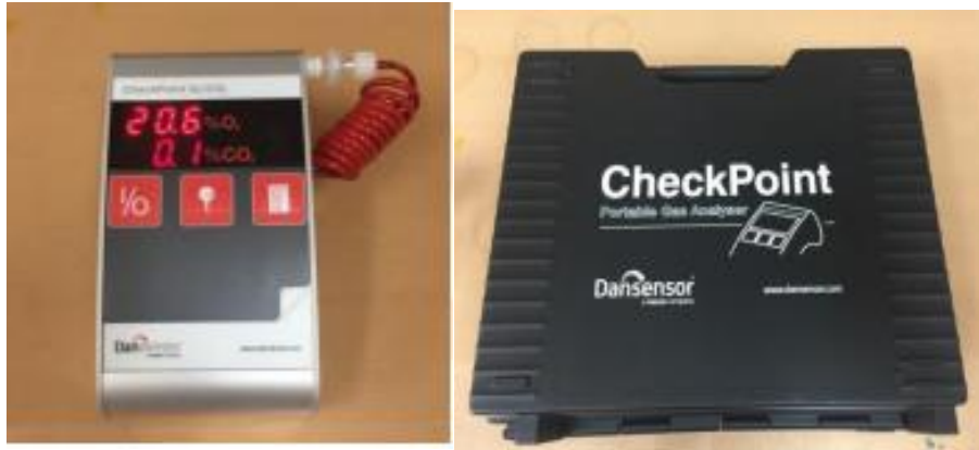
Şekil 2.3: Paket içi gaz atmosferinin ölçülmesinde kullanılan cihaz
