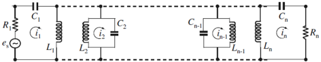
Şekil 4.1: Çevre akımları formülasyonu için n-kuplajlı rezonatörlerin eşdeğer devresi.
