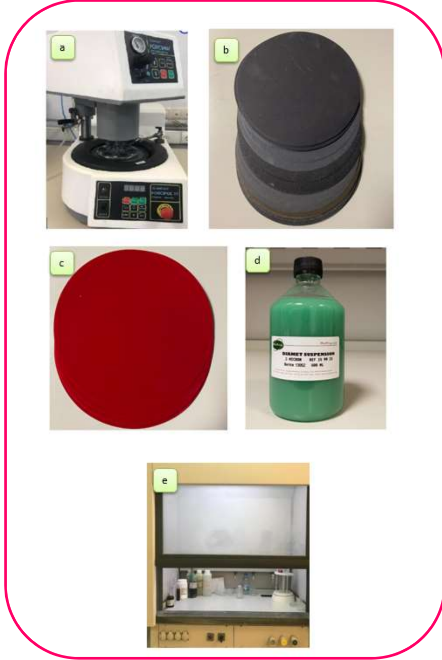
Şekil 7.39: Metalografik İşlemler, a) Otomatik zımparalama ve parlatma cihazı ,b) Zımpara kağıtları, c) Parlatma çuhası,d) Parlatma solüsyonu, e) Dađlama iřleminin yapıldığı çekerek ocak
