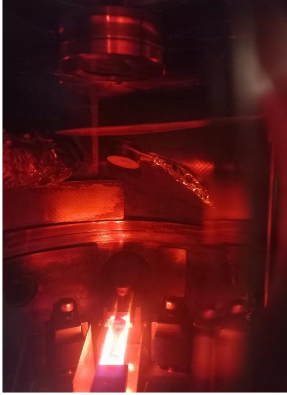
Şekil 3.6: PVD yönteminde, potadaki toz polikristalin görüntüsü.
