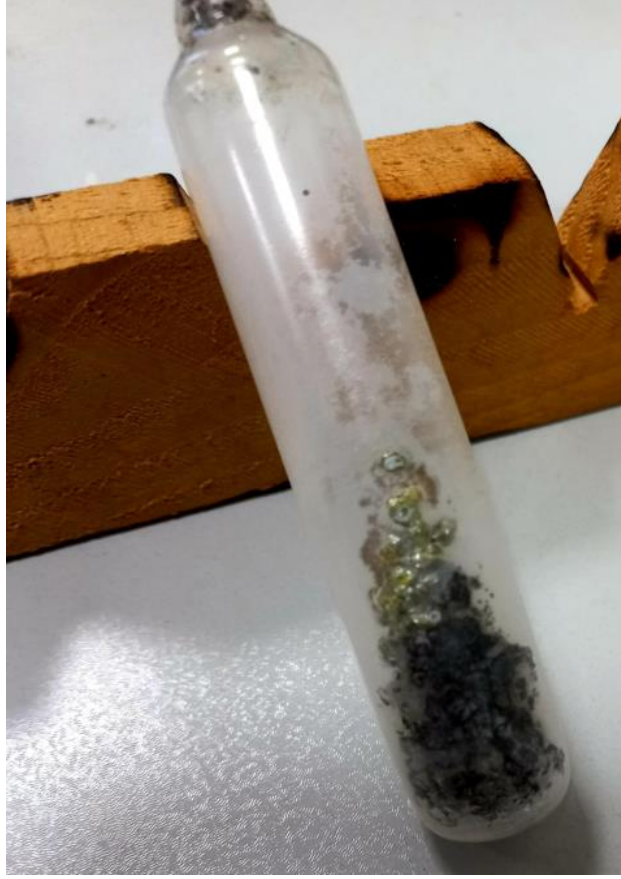
Şekil 3.1: Kuvartz tp ierisinde sinterlenen ZnSe:Ag.
