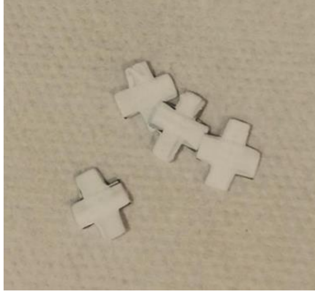
Şekil 3.8: Teflon bant ile sarılmış bakır maskeler (Şahin 2020).
