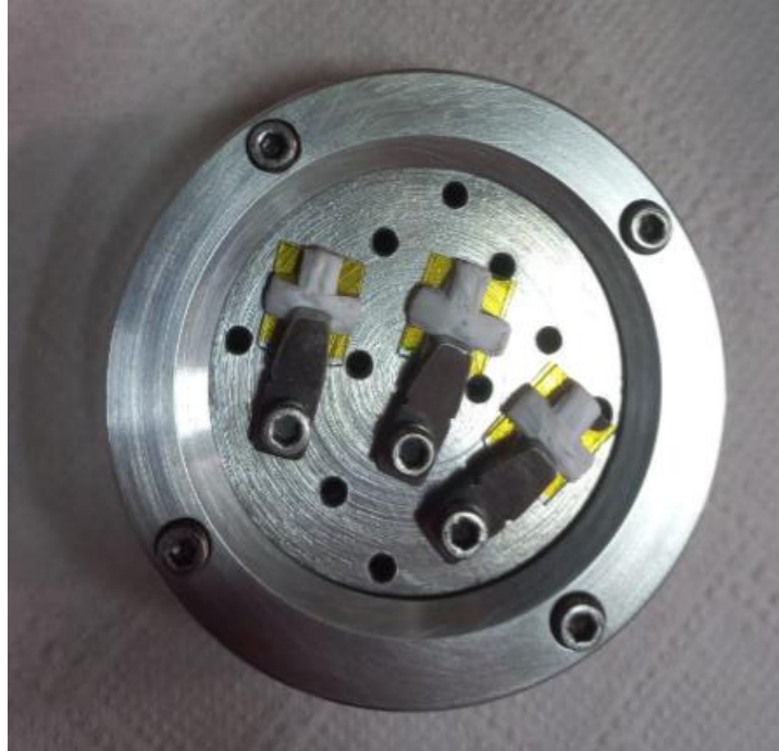
Şekil 3.9: Ag kontak büyütme öncesi tutucu üzerinde ince filmler.
