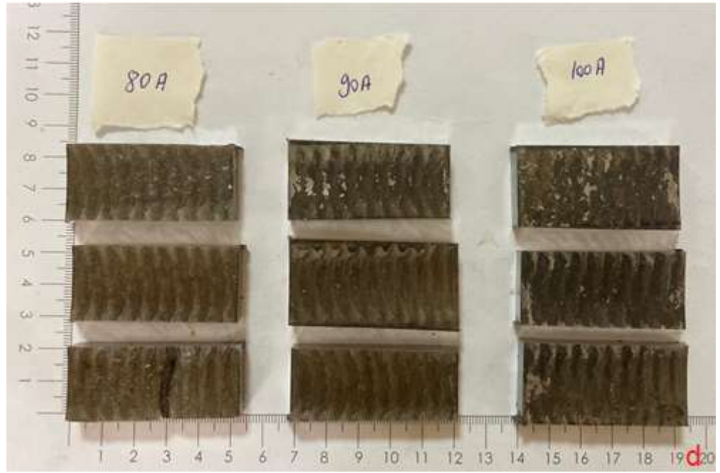
Şekil 3.11: a) Numune 1'e ait test öncesi görüntü, b) Numune 2'ye ait test öncesi görüntü, c) Numune 3'e ait test öncesi görüntü, d) Numune 2.1, 2.2 ve 2.3'e ait test öncesi görüntü.
