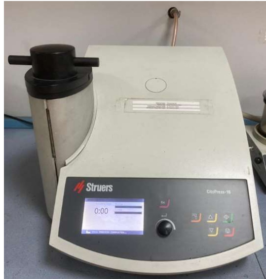
Şekil 3.14: Struers CitoPress-10 marka bagalite alma cihazı
