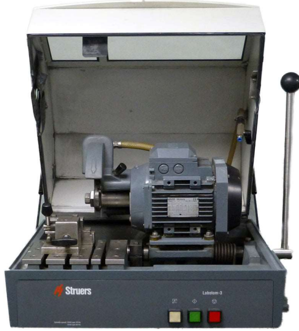
Şekil 3.13: Struers lobotom 3 marka soğuk kesme cihazı
