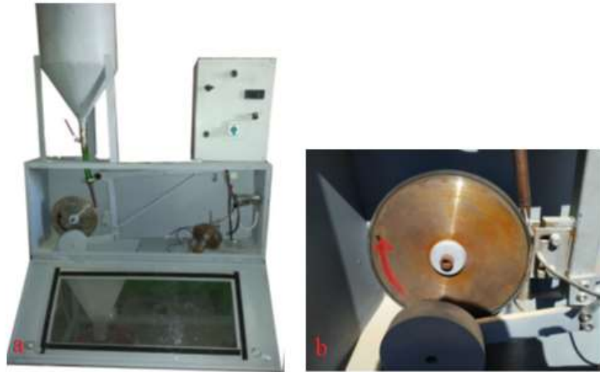
Şekil 3.12: a) Aşınma test düzeneği görüntüsü, b) Test anında alınan bir görüntü.
