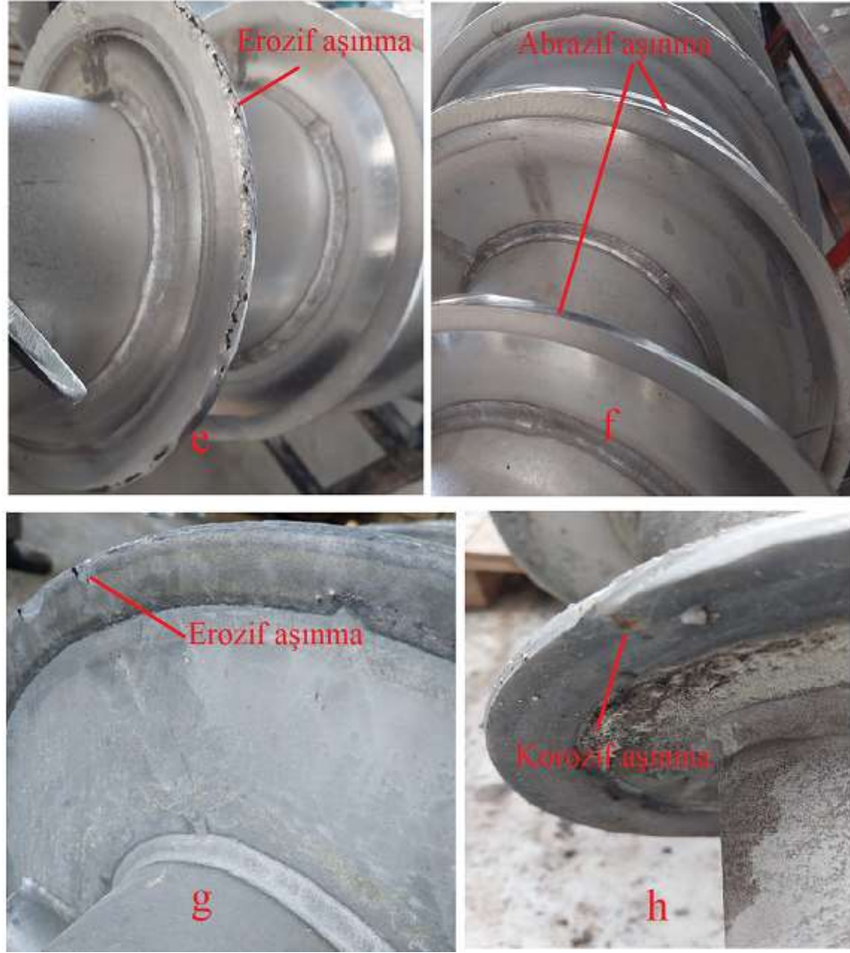
Şekil 1.2: Kanatlarda meydana gelen aşınma örnekleri
