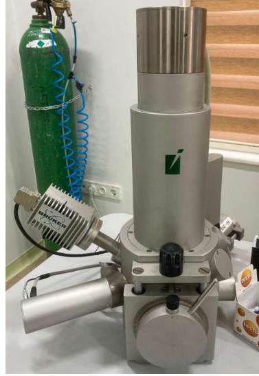
Şekil 3.17: Tescan Vega 2 model EDX cihazı
