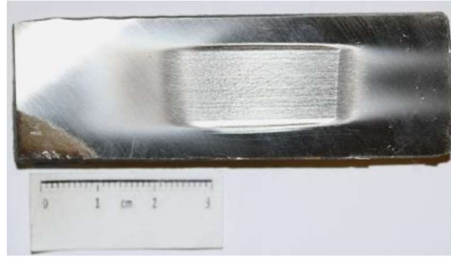
Şekil 4.1: Test sonrası AISI 304 altlık malzeme görüntüsü
