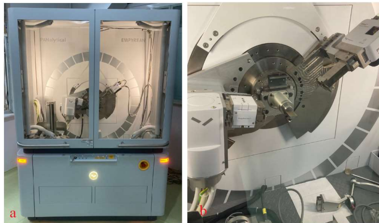
Şekil 3.18: a) Malvern Panalytical Empyrean marka XRD cihazı, b) XRD analizi anından alınan bir görüntü.
