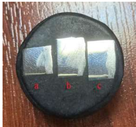
Şekil 3.16: a) Numune 2.1 için bagalite alınmış ve yüzeyi parlatılması, b) Numune 2.2 için bagalite alınmış ve yüzeyi parlatılması, c) Numune 2.3 için bagalite alınmış ve yüzeyi parlatılması,
