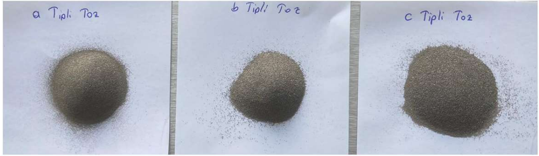
Şekil 3.2: a, b ve c tozlarının 3d mikser ile karıştırılması sonrası görüntüleri
