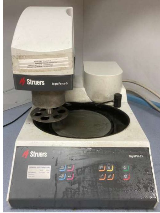
Şekil 3.15: Struers TegraPol-21 marka yüzey parlatma cihazı
