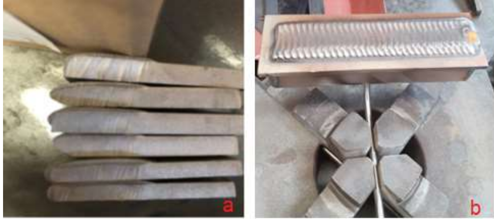
Şekil 3.7: a) Alev sprey ve soğutmasız PTA ile kaplanan numuneler b) Soğutmalı PTA ile kaplanan numuneler
