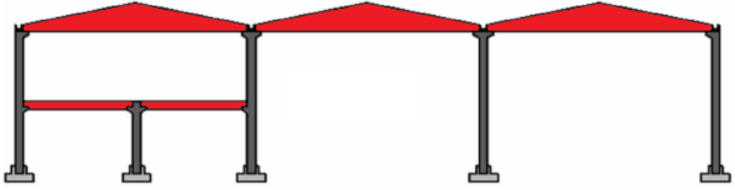
Şekil 3.3: Tipik karma prefabrik yapının örnek gösterimi
