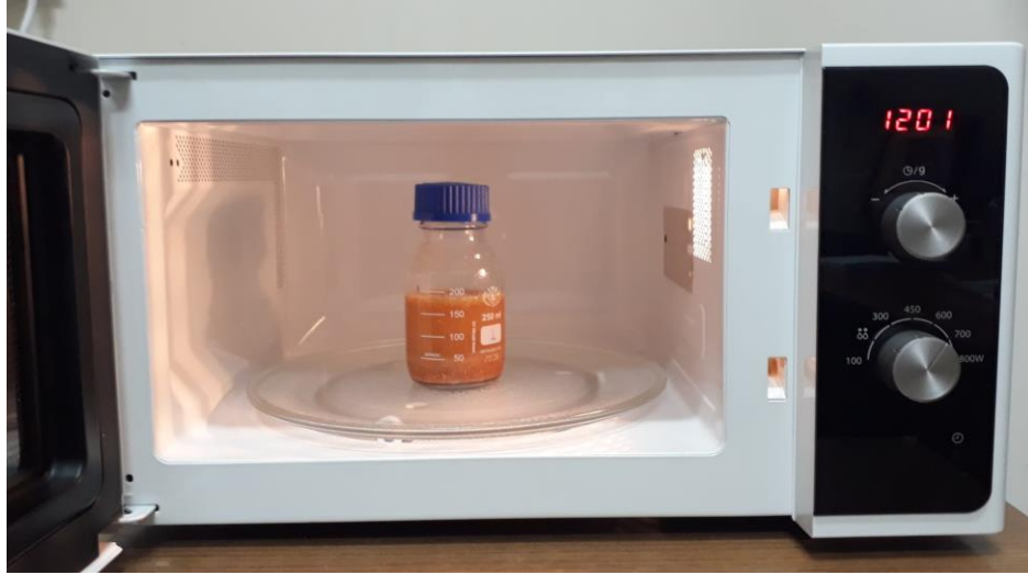
Şekil 3.3: Mikrodalga destekli ekstraksiyon yönteminin gerçekleştirildiği ev tipi mikrodalga fırın
