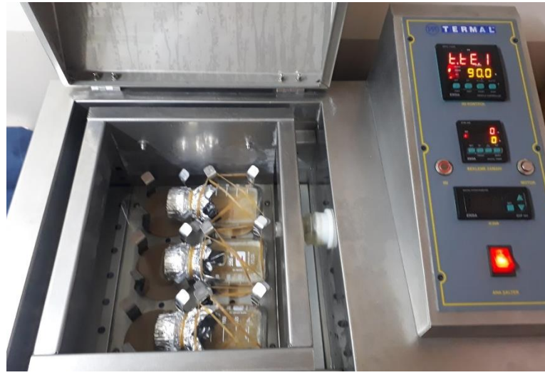
Şekil 3.2: Sıcak asit ekstraksiyon yönteminin gerçekleştirildiği çalkalamalı su banyosu
