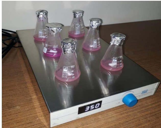
Şekil 4.4: Soğan ve sarımsak atıklarından üretilen pektin örneklerinin sabunlaşma reaksiyonundaki görünümleri
