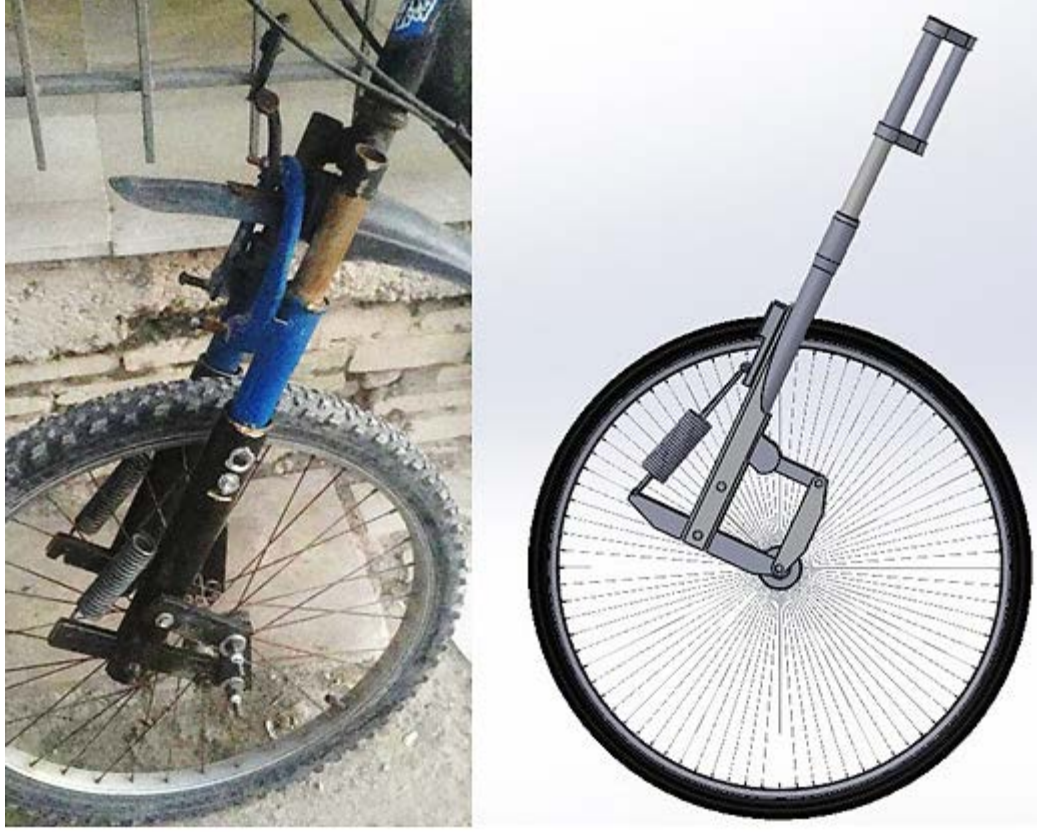
Şekil 4.4 İlk Deneysel Mekanizma ve İlki Üzerinden Gelişen Tasarım
