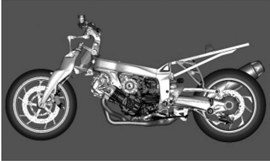
Şekil 2.6 BMW K1200 S Duolever Süspansiyonu (Berkmann 2004)
