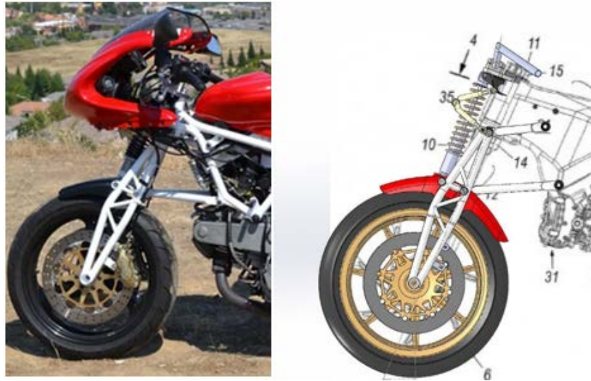
Şekil 1.4 Hossack boru yapısı (Hossack 2007)
