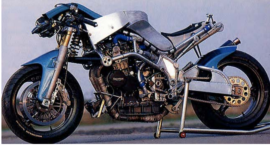
Şekil 1.6 Saxon Süspansiyonuna Sahip Triumph (Radika 1984)
