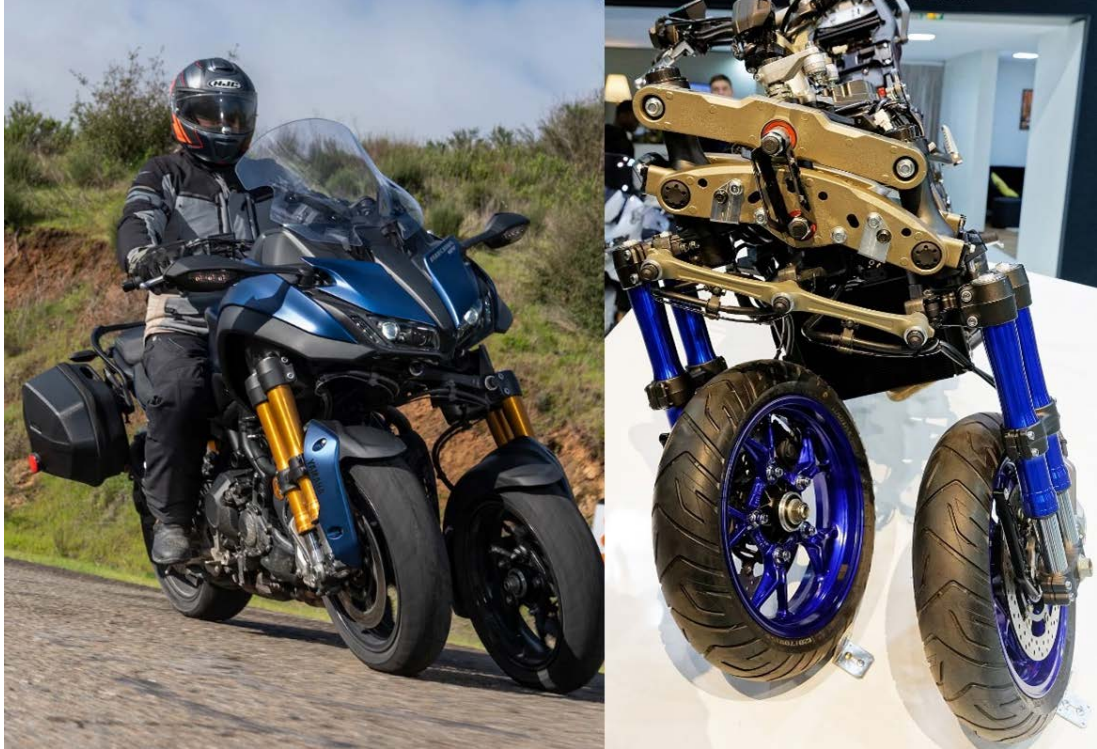
Şekil 2.8 Yamaha Niken ve Ön Süspansiyonu (Yamaha 2020)
