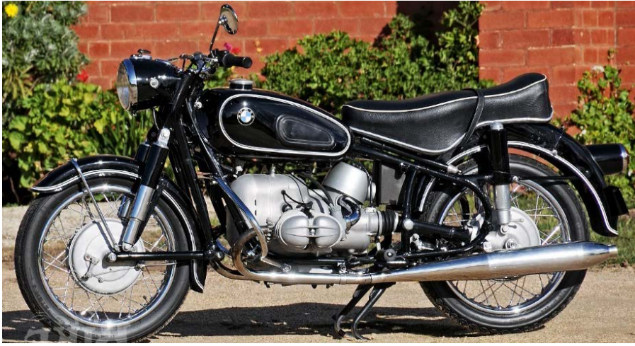
Şekil 2.2 BMW R69S Earles Süspansiyonu (Falloon 2003)
