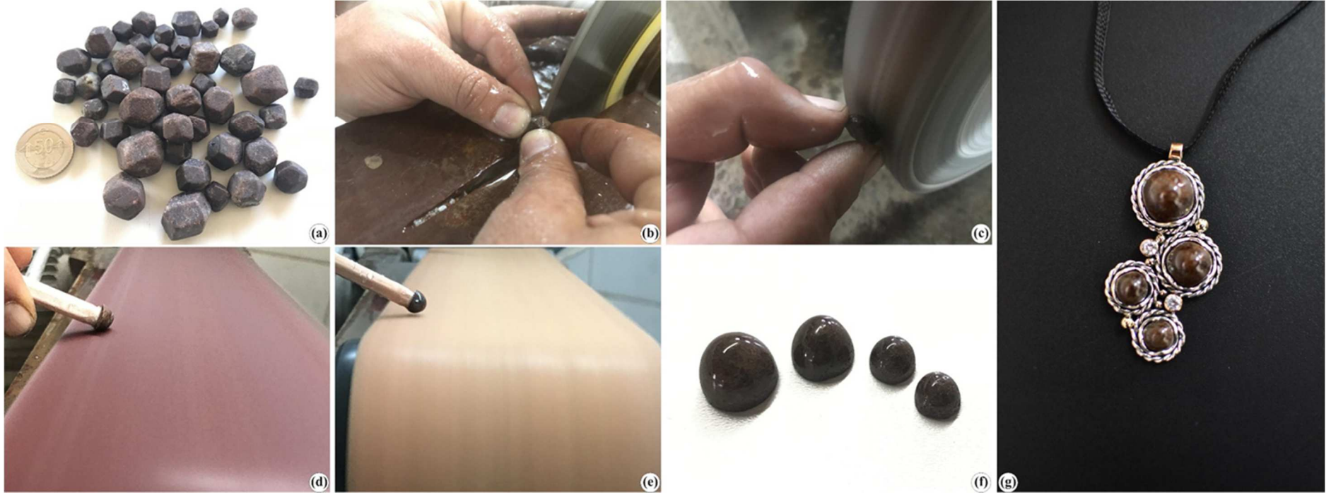
Şekil 2.15: a) Tamburlanmış granat porfiroblastları, b) granat porfiroblastlarının elmas diskte kesilmesi c) elmas kaboşon diskte işlenmesi, d) 320 ve 600 kum bant zımparada yüzey pürüzlülüğünün giderilmesi, e) seryum-oksit bant üzerinde parlaklık verilmesi, f) bütün işlemleri bitmiş ve kullanıma hazır granat porfiroblastları, g) Gümüş ve bronz kullanılarak takıya dönüştürülmüş granat porfiroblastları.
