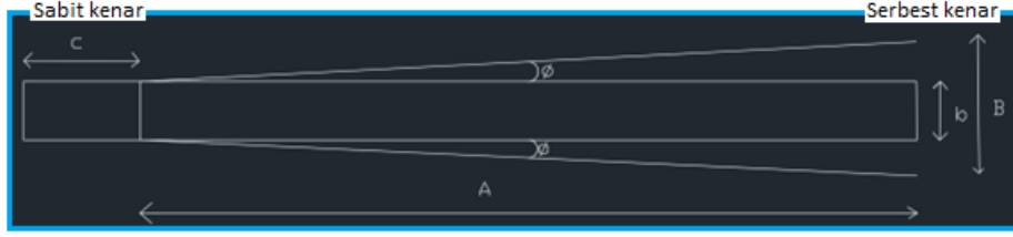
Şekil 4.15: 1. Seri test numunesinin ankastre test düzeneğine bağlanma konumu.
