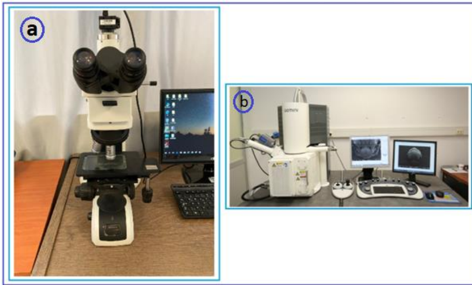
Őekil 4.12: Yzey analiz iřlemlerinde kullanılan cihazlar, a) 50X – 1000X bytme oranına sahip optik mikroskop cihaz grnts, b) Ayrıntılı yzey analizi iřleminde kullanılan FESEM analiz cihazı.
