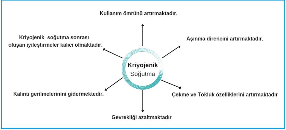
Şekil 2.12: Kriyojenik soğutma sonrası kazanılan özellikler.
