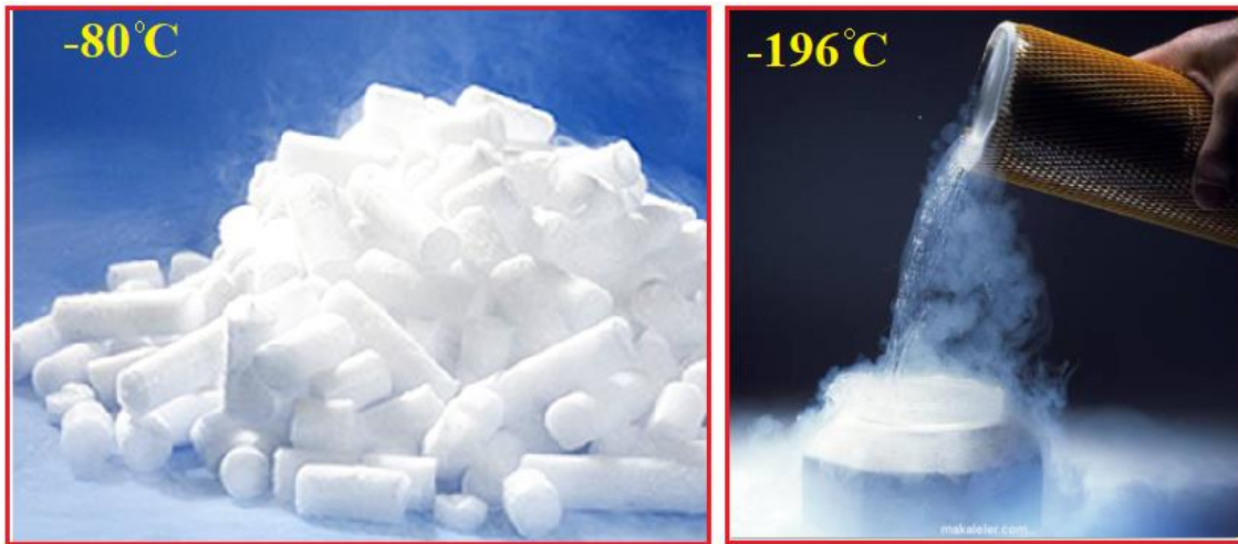
Şekil 2.11: Kuru buz (Sığ-kriyojenik) ve sıvı azot (Dip Kriyojenik) (Spur ve diğ. 1999).
