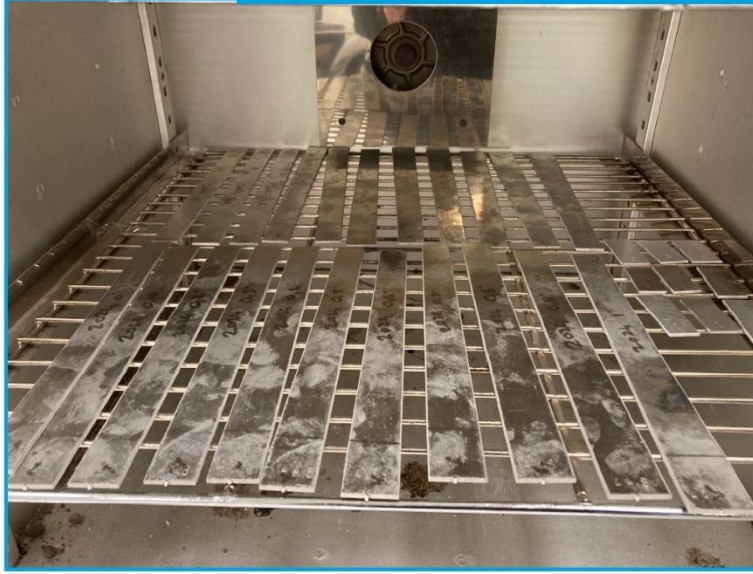
Yaşlandırma ısı işlem aşaması (160°)
