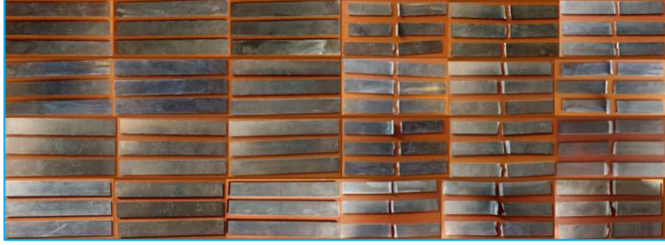
Şekil 3.38: Üç nokta eğme öncesi ve sonrası numunelerin halleri
