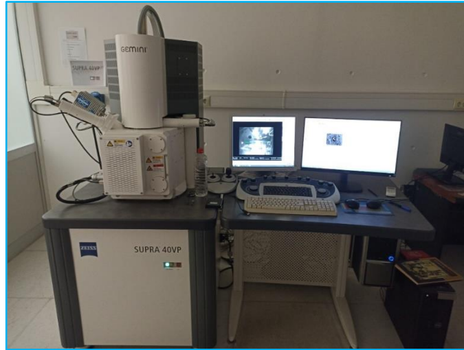
Şekil 3.23: Deney numunelerinin analizinde kullanılan SEM cihazı
