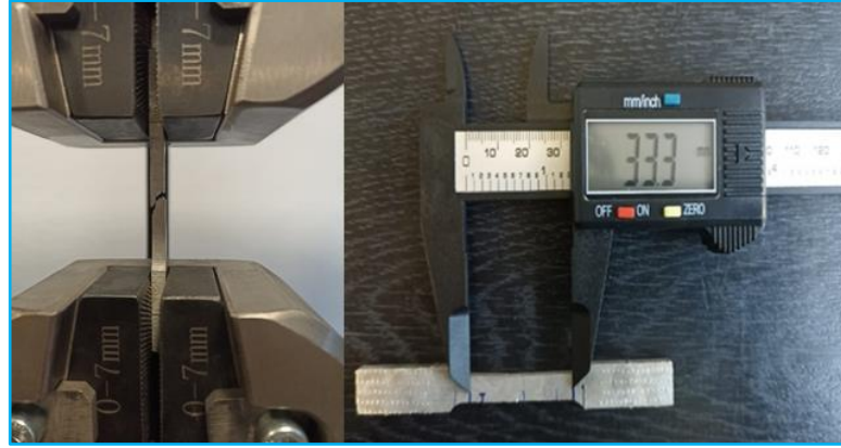
Şekil 3.35: Çekme deneyi sonrası kopan numune ve son ölçü boyunun ölçülmesi
