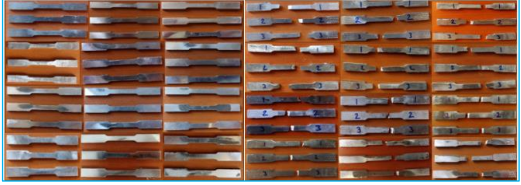
Şekil 3.34: Çekme testi öncesi ve sonrası numunelerin durumları
