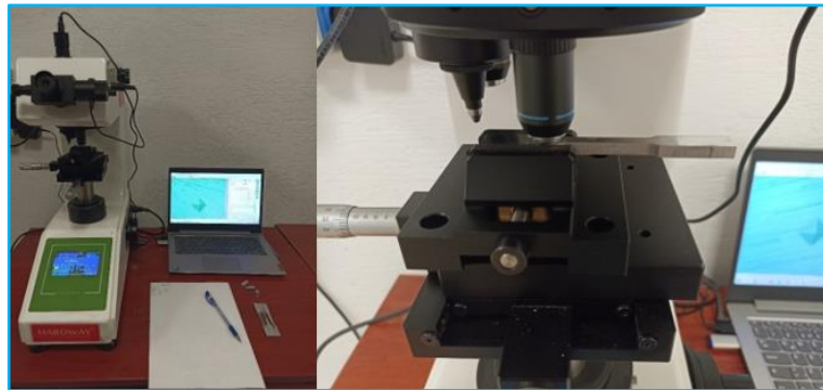
Şekil 3.30: Sertlik ölçümlerinin yapıldığı mikro Vickers cihazı
