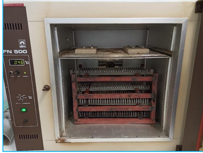
Şekil 3.16: T6I4 ısıtıl işleminin AA2024 ve AA7075 alaşımlarına uygulanması
