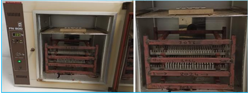
Şekil 3.18: AA7075 alaşımına T6I6 ısıl işleminin uygulanması ve deney numuneleri
