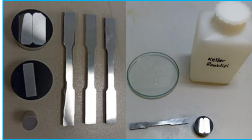
Şekil 3.21: Parlatılmış numuneler ve dağlama işlemi
