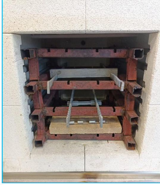
Şekil 3.12: T6 ısıtım işlem optimizasyonu çalışmasının yapıldığı ısıtım işlem fırını
