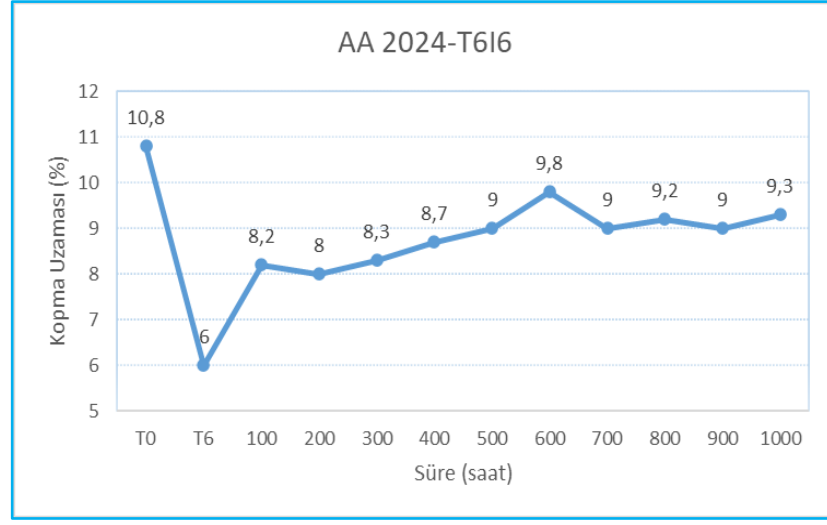
Şekil 4.15: AA2024 alaşımına ait T6 ve T6I6 ısıt işleml sonrası kopma uzaması değışimi
