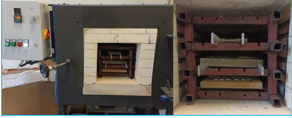
Şekil 3.17: AA2024 alaşımının T6I6 ısıl işleminin uygulanması ve deney numuneleri
