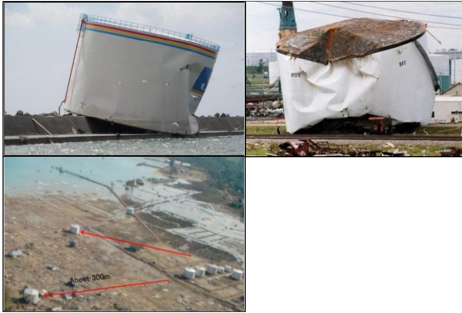
Resim 2.4: Tankın kayması (Anumod ve diğ. 2014), (Sari ve diğ. 2016), (Hamada 2016)
