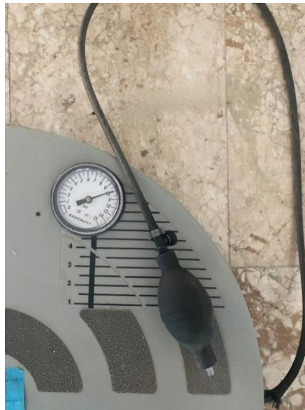
Resim 3.4.1.1.1 SportKat 550-TS cihazının hareketli denge platformundaki el pompası ve basınç göstergesi
