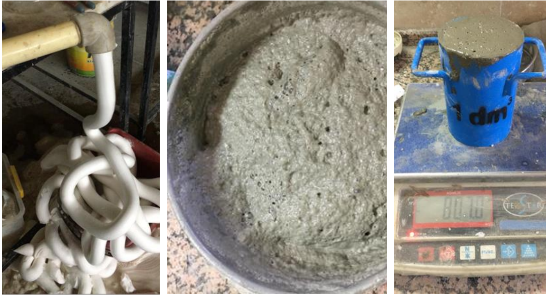
Şekil 3.18: Köpüğün sisteme verilmesi ve birim hacim ağırlığının belirlenmesi
