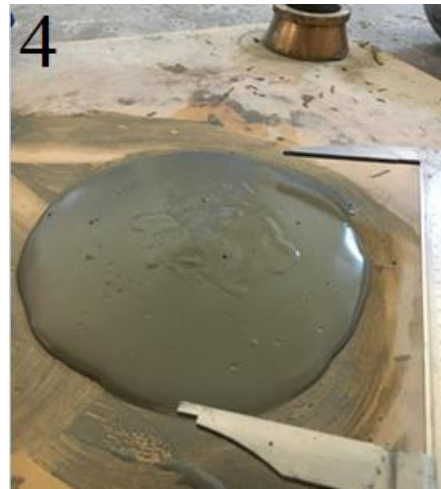
Şekil 3.12: 1: Ace450 oranı=%0.4 yayılma tablası değeri 15,5cm; 2: Ace450 oranı=%0.5 yayılma tablası değeri 19cm; 3: Ace450 oranı=%0.6 yayılma tablası değeri 30cm; 4: Ace450 oranı=%0.5 (tekrar deneme) yayılma tablası değeri 22 cm
