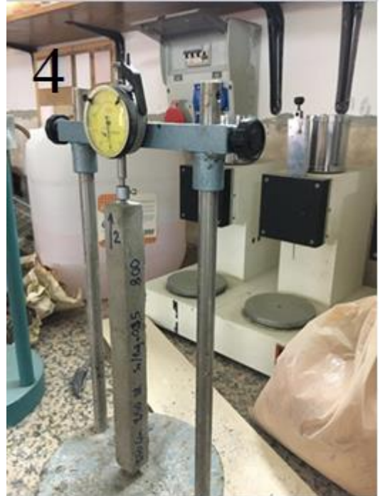
Şekil 3.4: Kullanılan cihazlar (1: Üç noktalı eğilme aparatı; 2: Basınç aparatı; 3: Isıl iletkenlik ölçüm cihazı; 4: Kuruma kaynaklı büzülme test cihazı)
