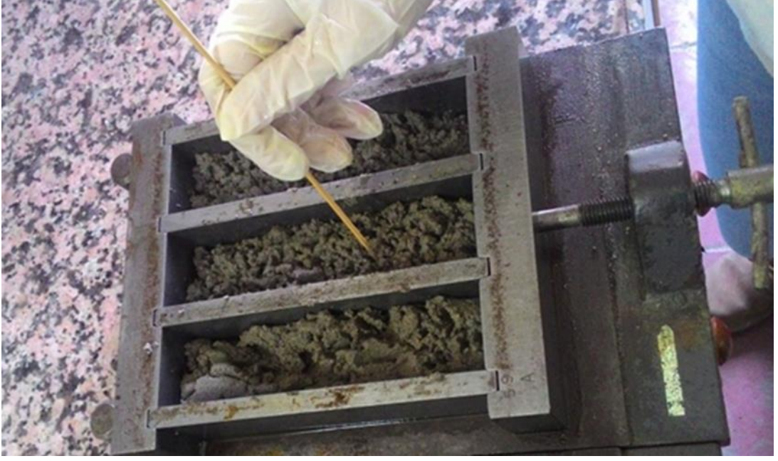
Şekil 3.8: Numunelerin kalıba yerleştirilmesi
