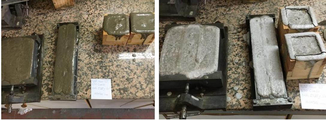
Şekil 3.21: Çökme gözlemlenen 0.50 su/bağlayıcı oranına sahip numuneler
