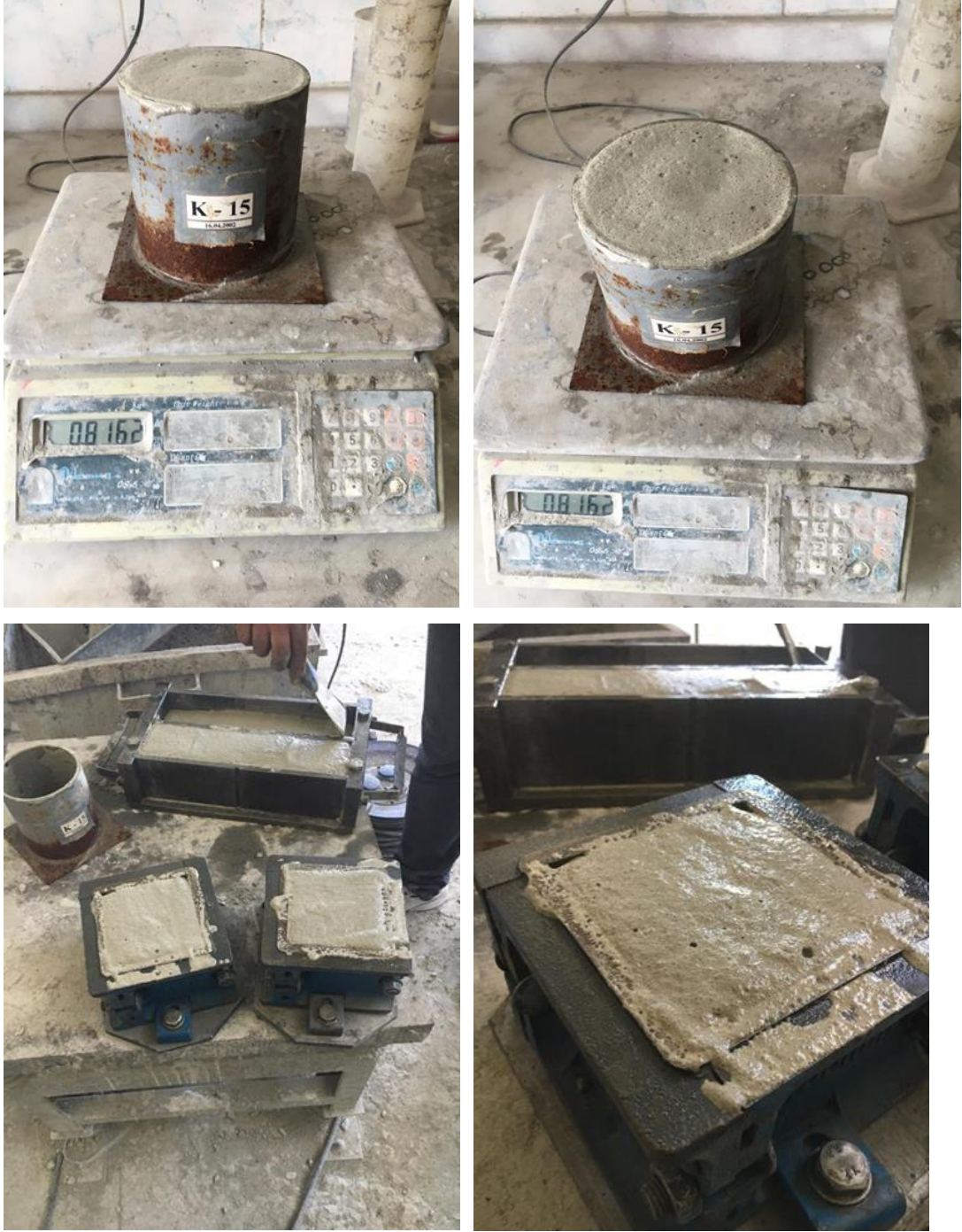
Şekil 3.13: İlk üretilen köpük beton denemeleri
