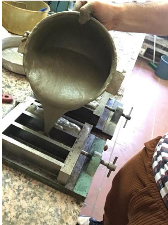
Şekil 3.20: KYB kıvamındaki köpük betonlar
