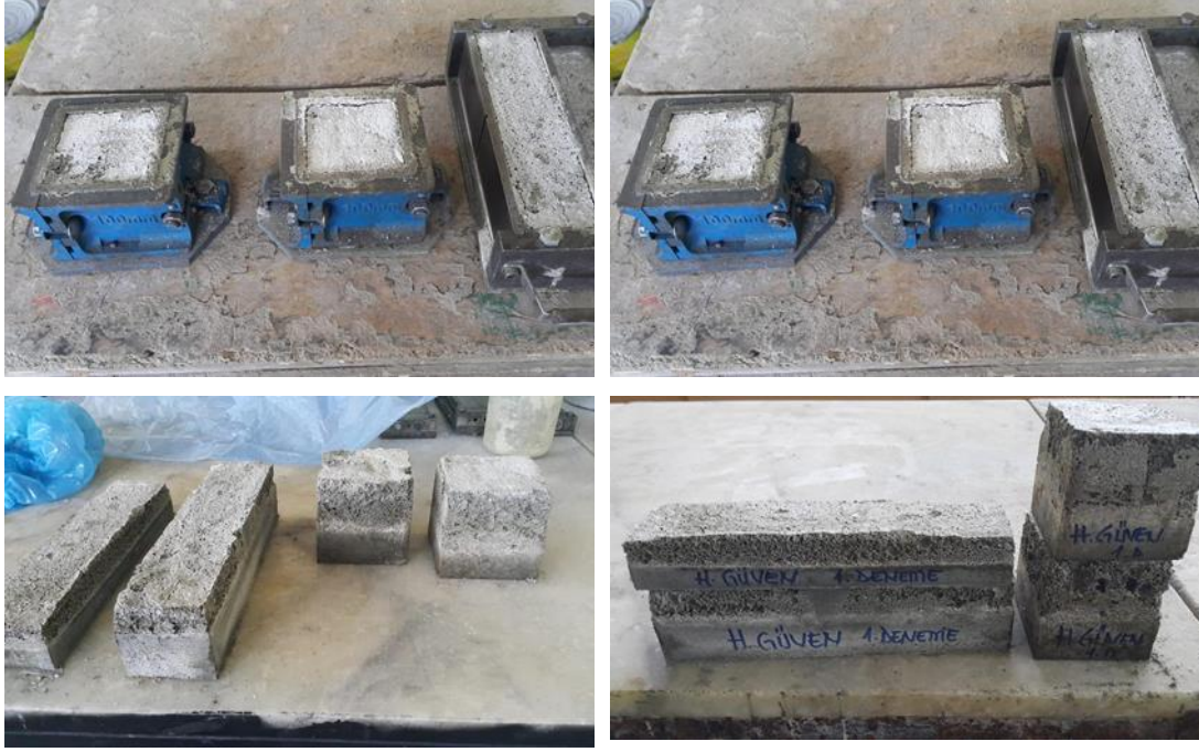
Şekil 3.14: İlk üretimlerdeki çökelme problemi
