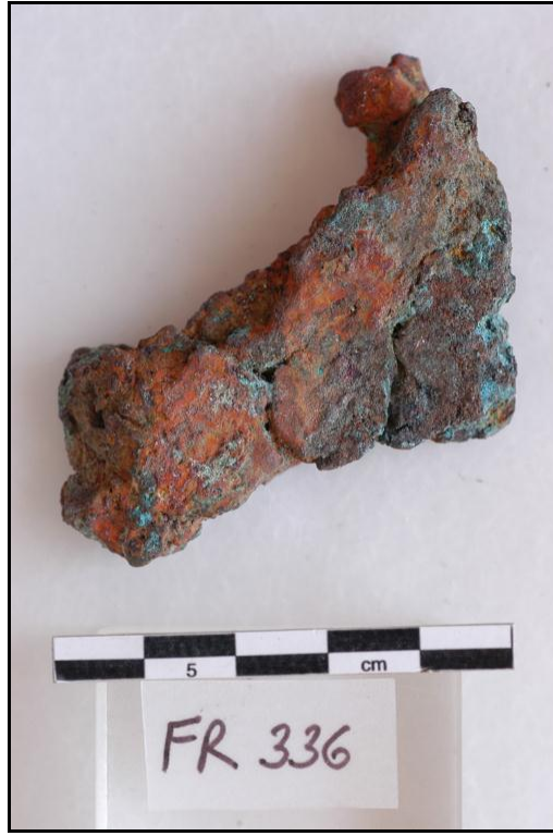
Resim 7: Yüzeyi dövülerek düzlenmiş külçe parçası.
