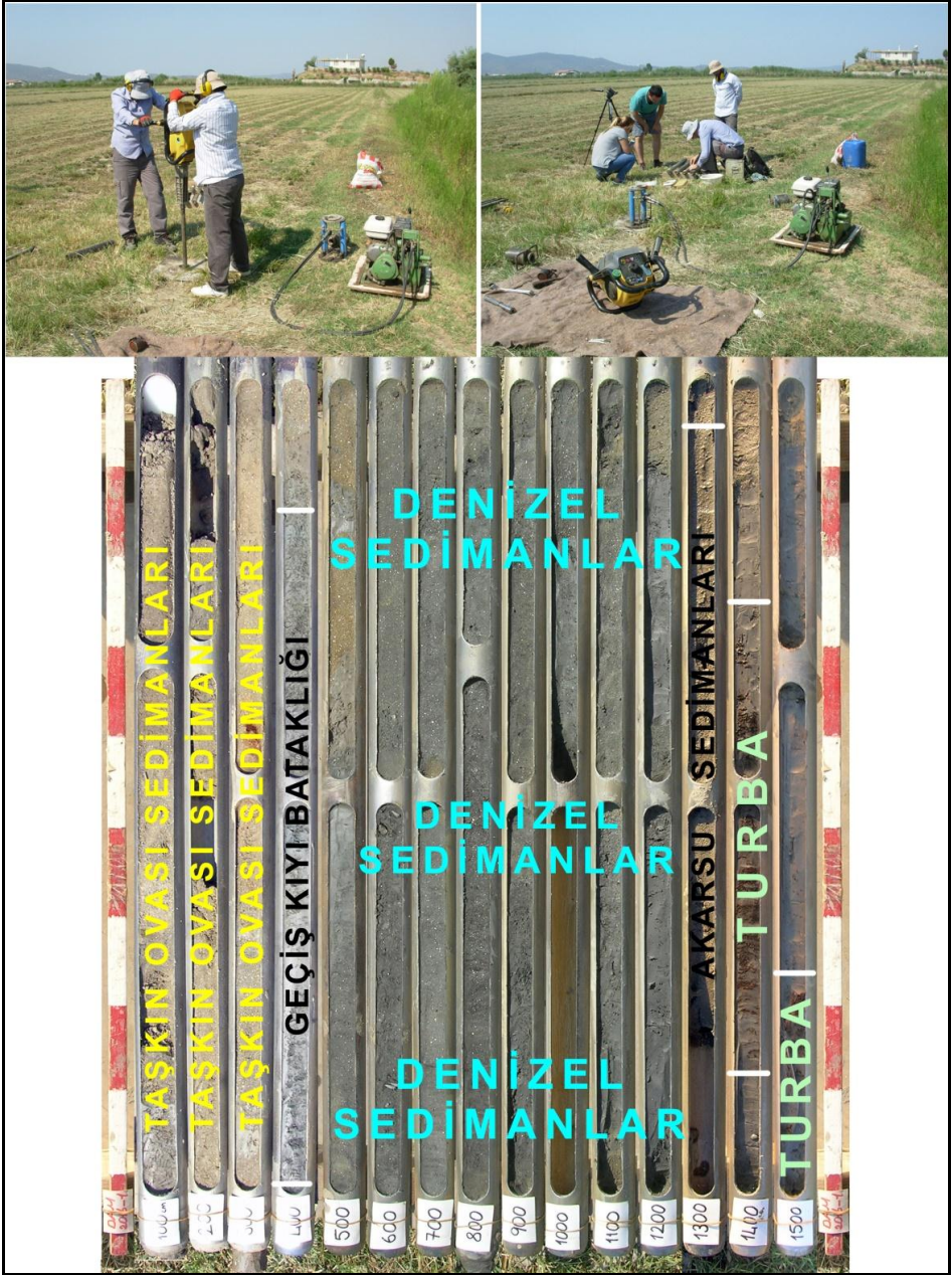
Resim 3. Güllük körfezi kıyıları ile Pilav tepe arasındaki 15 metre derinliğe inilen DAM-01 numaralı sondaj çalışmalarını ile bu sondaja ait sedimanlar ve yansıttıkları ortam özellikleri.
