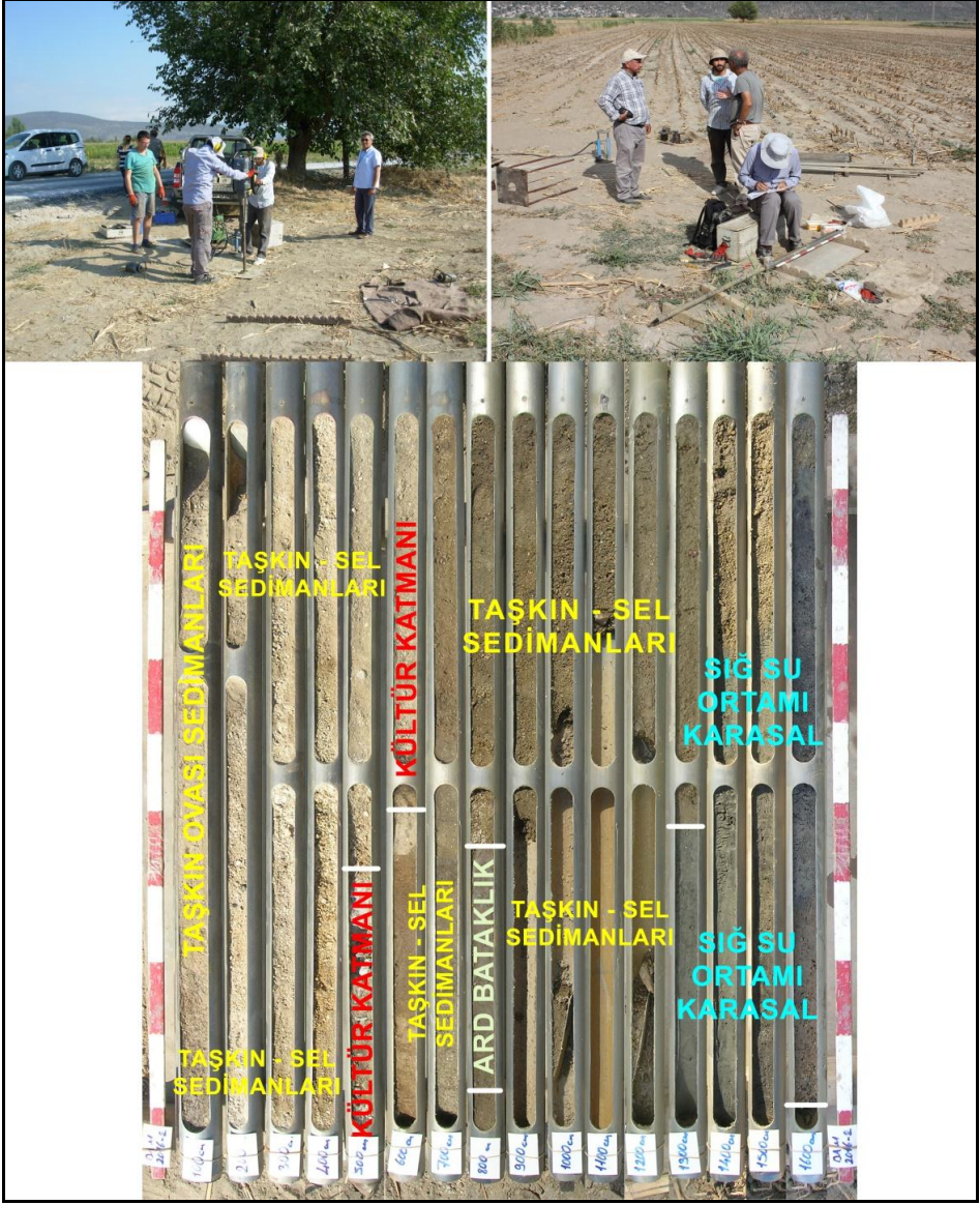
Resim 7. Damlıboğaz önlerindeki ovardaki 16 metre derinliğe inilen DAM-02 numaralı sondaj çalışmalarını ile bu sondaja ait sedimanlar ve yansıttıkları ortam özellikleri.
