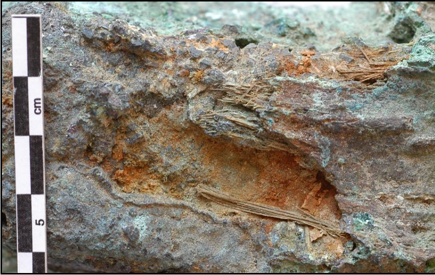
Resim 6: Bakır külçe yüzeyinde gözlenen organik lifler.
