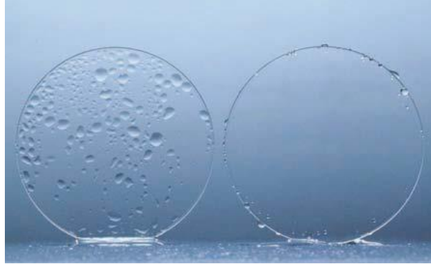
Şekil 3. Hidrofilik ve hidrofobik cam yüzeyler
