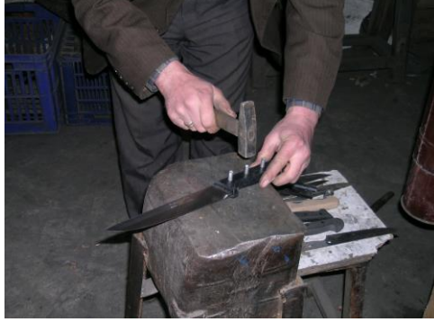
Şekil21. Sapla gövdenin perçinle birleştirilmesi
