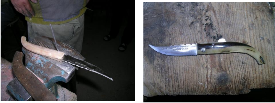
Şekil 20. Sapla Gövdenin Birleştirilmesi
