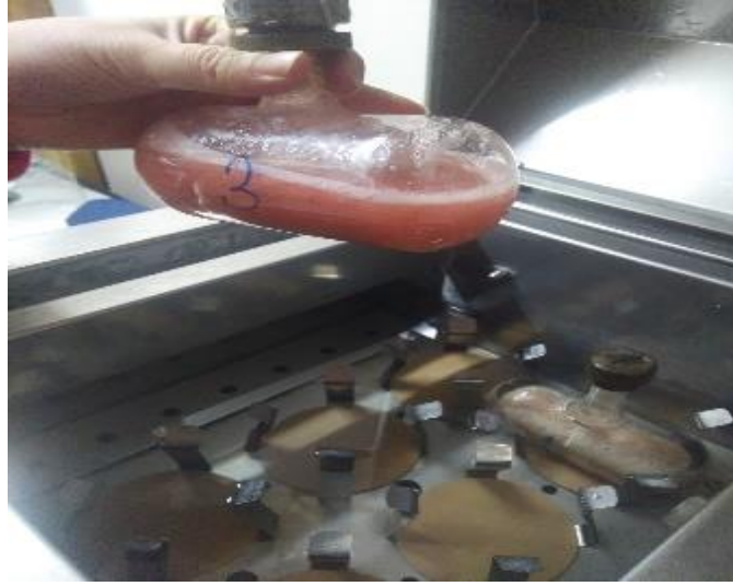
Şekil 3.2: SAE yöntemiyle pektin ekstraksiyonunda kullanılan çalkalamalı su banyosu.
