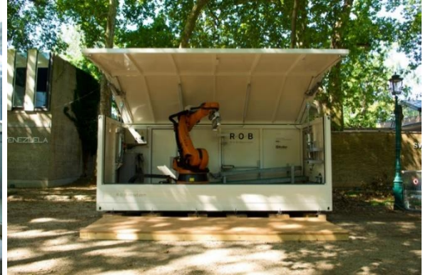
USC Mühendislik Profesörü Behrokh Khoshnevis'in yerinde inşa yapabilecek olan prototip 3D Robotik Makinesi (URL15)
