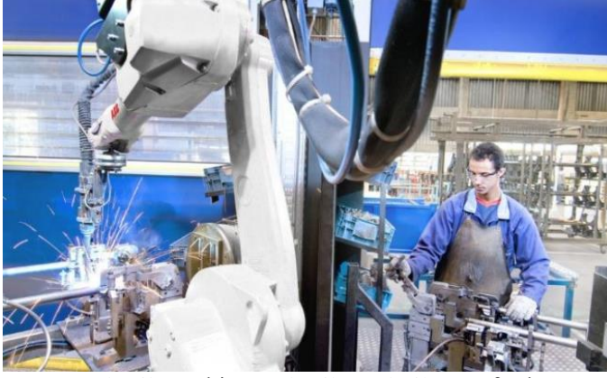
ABB Robotik Türkiye Robotik Teknik tarafından otomotiv sektörü için üretilen argon kaynağı birleştirme makinesi (URL14)
