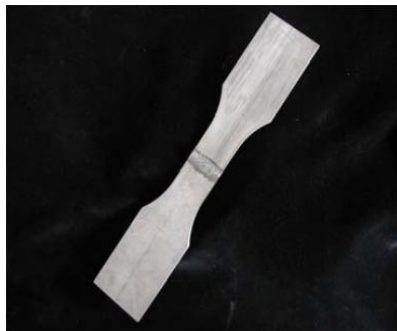
Şekil 3.7: Kök aralıksız çift V-dikişli alın dikişi; K_t = 1,64 (Karakaş 2006).
