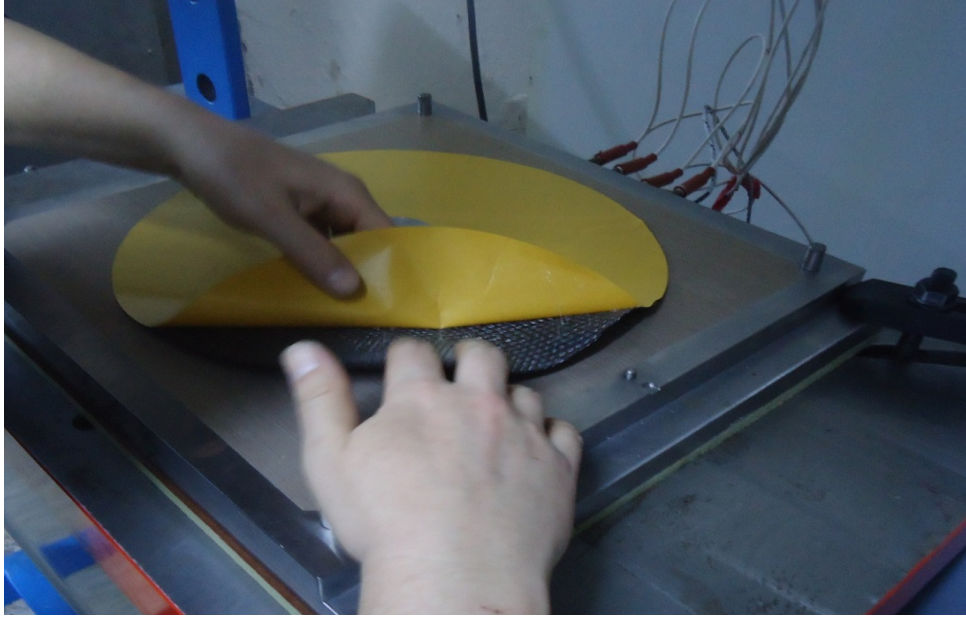
Şekil 3.13: Pre-preglerin alt kalıba yerleştirilmesi
