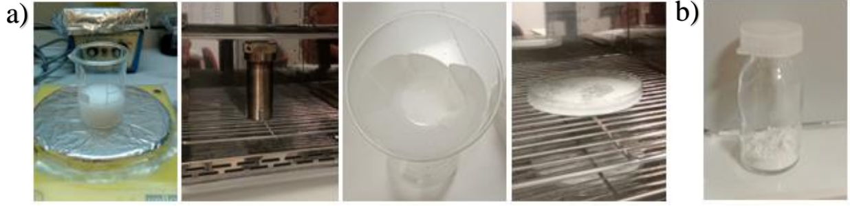
Şekil 3.3 : a) Hidrotermal reaktör içerisinde BaTiO 3 nanoparçacığının üretimi, b) Tüm işlemler sonucunda elde edilen toz BaTiO 3 nanoparçacığının görüntüsü.
