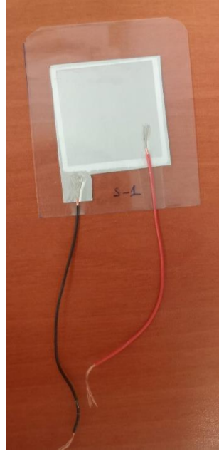
Şekil 3.7 : a) Oluşturulan PENG yapısının şematik gösterimi, b) Elektriksel ölçüm için hazırlanan PENG yapısı, c) Tasarlanan PENG'in resmi.
