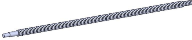
Şekil 3.42: Vidalı mil 3 boyutlu tasarımı
