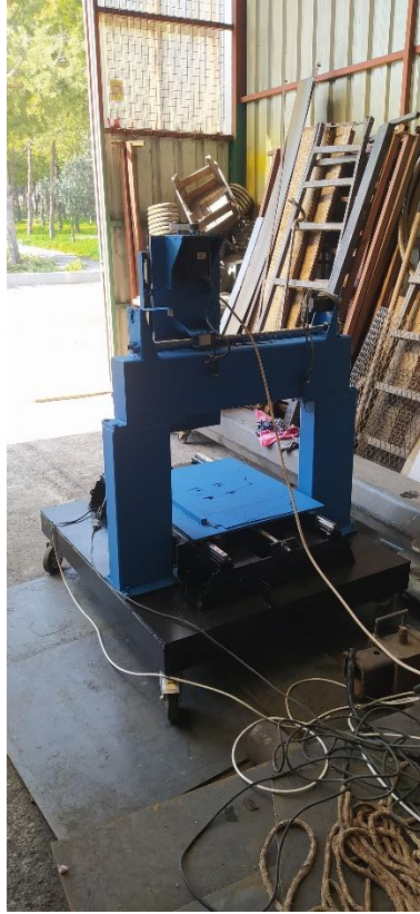
Şekil 3.74: CNC Router Mekanik Kısım Son Montajı-3
