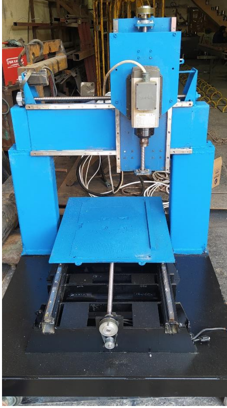
Şekil 3.73: CNC Router Mekanik Kısım Son Montajı-2
