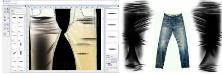
Şekil 4.3: Lazer ışını ile denim kumaşlarda büyük deseni oluşturma (Batur ve Ayranpınar 2021)
