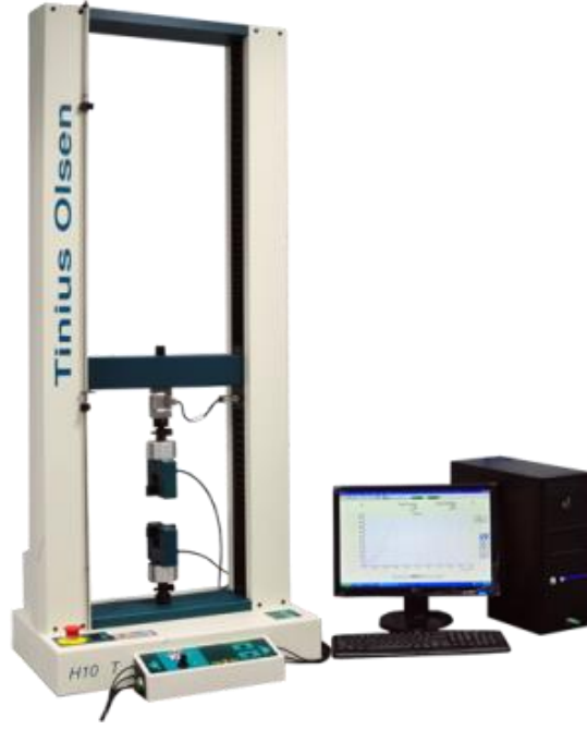
Şekil 6.14: Tinius Olsen H10KT üniversal çekme mukavemeti test cihazı
