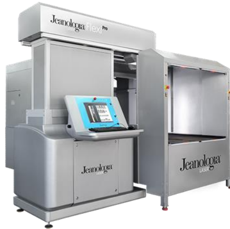
Şekil 6.8: Jeanologia flexi e marka lazer yakılma makinesi (Url_19)
