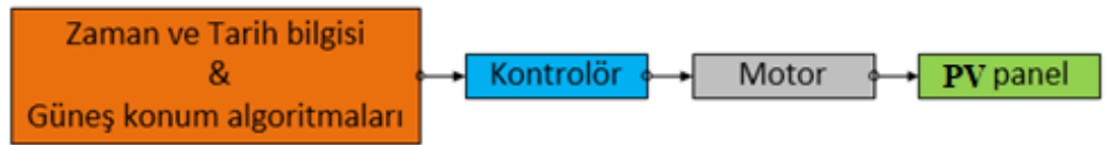
Şekil 3.31: Açık çevrim kontrol yapısının genel gösterimi (Menak 2018)
