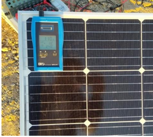
Şekil 4.4: Çalışmada kullanılan panelin açısı, ışınım ve yüzey sıcaklığı ölçümü
