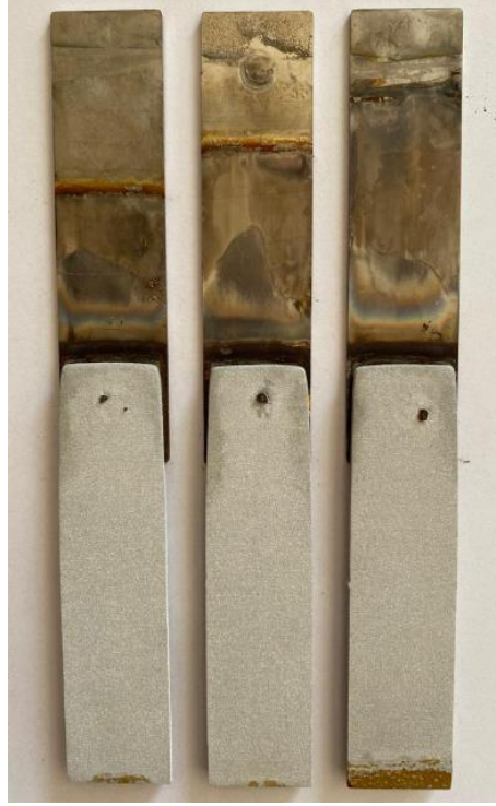
Şekil 7.2 AA5083- AISI 304 (7 kA) numunelerinin korozyon testi sonrası arka yüz görüntüleri.
