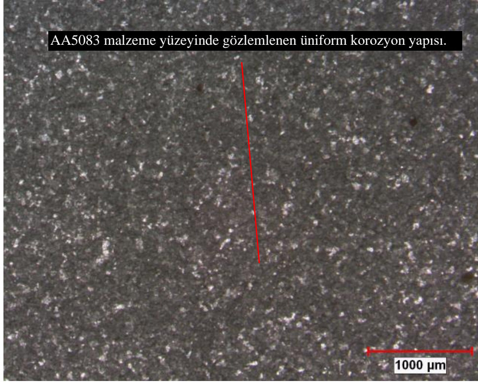
Şekil 7.19 Korozyon testi sonrası AA 5083 malzemenin yüzeyine ait makroyapı görüntüsü (20X)
