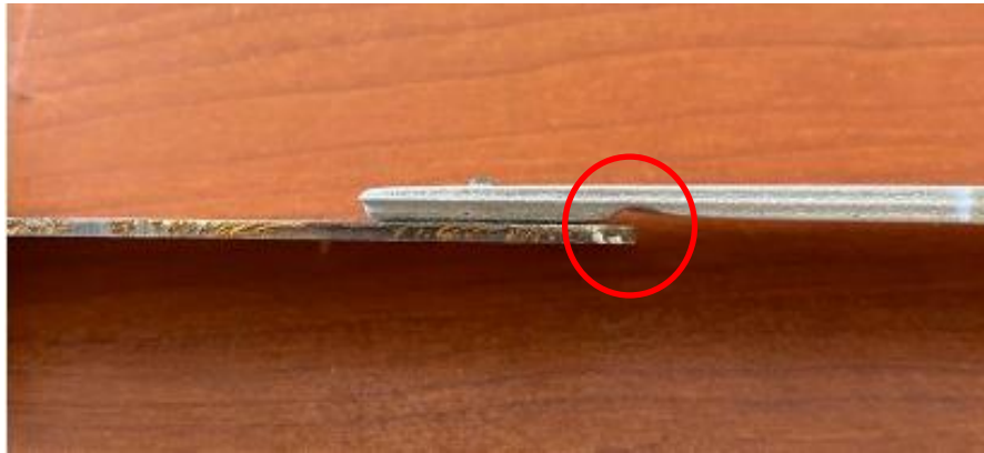
Şekil 7.5 AA5083- AISI 304 numunenin korozyon testi sonrası yan yüz görüntüsü.
