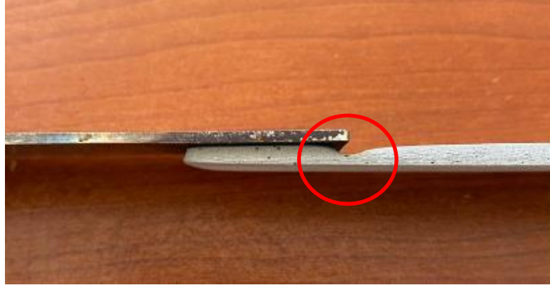
Şekil 7.6 AA5083- AISI 304L numunenin korozyon testi sonrası yan yüz görüntüsü. Şekil 7.5 ve Şekil 7.6’ da AISI 304-AA 5083 ve AISI 304L-AA 5083 malzeme çiftlerinden alüminyum malzemelerin uğradığı bölgesel korozyon görülmektedir.
