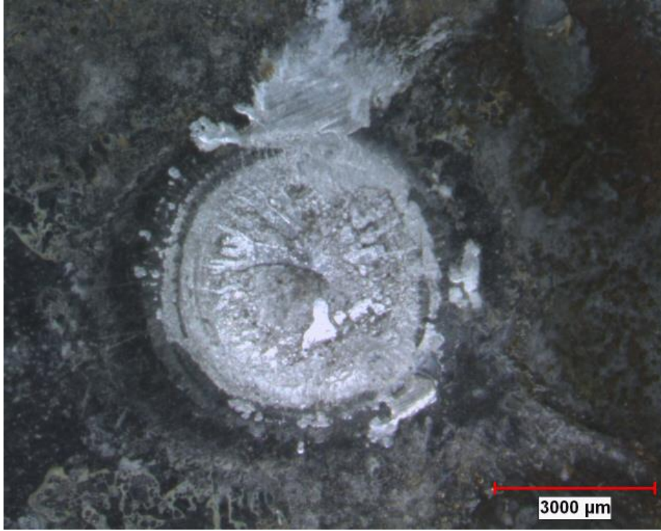
Şekil 7.14 Korozyon testi sonrası AISI 304L malzemenin kaynak bölgesine ait makroyapı görüntüsü (7,5X).
