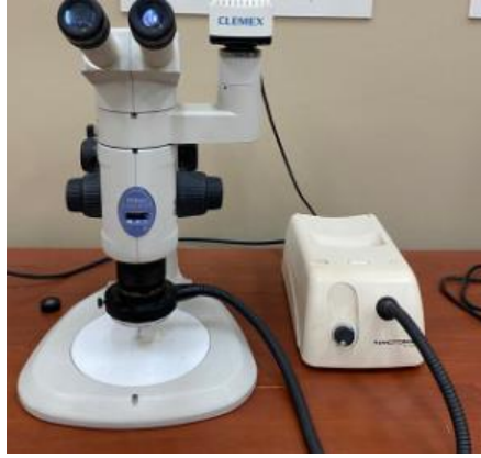
Şekil 6.11 Makroyapı görüntülerinin alındığı optik mikroskop.
