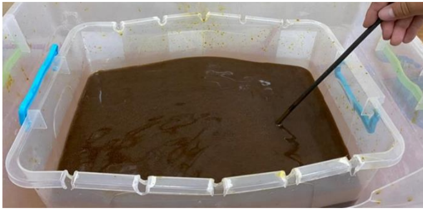
Şekil 6.6 Korozyon testi için demir klorür çözeltisinin hazırlanması.
