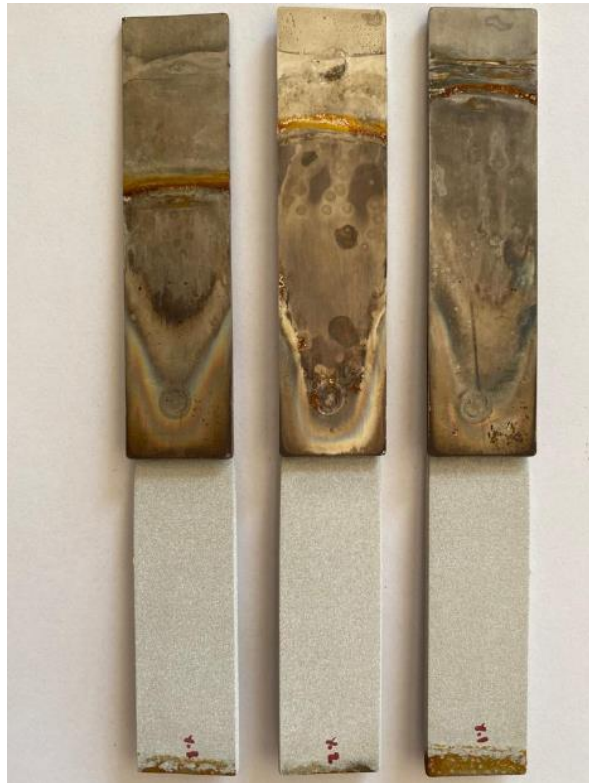
Şekil 7.1 AA5083- AISI 304 (7 kA) numunelerinin korozyon testi sonrası ön yüz görüntüleri.
