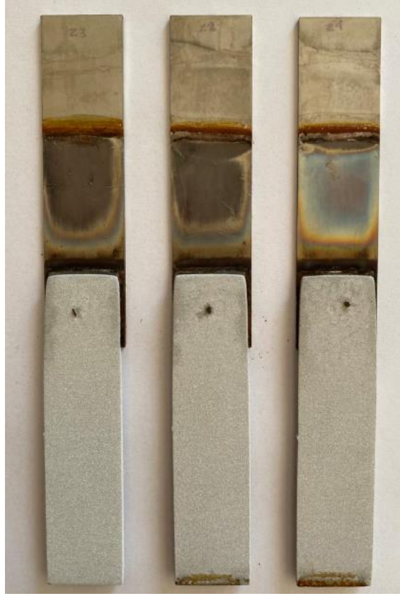
Şekil 7.4 AA5083- AISI 304L (7 kA) numunelerinin korozyon testi sonrası arka yüz görüntüleri.
