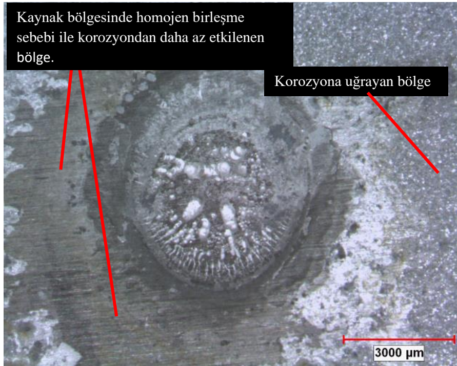
Şekil 7.13 Korozyon testi sonrası AA 5083 malzemenin kaynak bölgesine ait makroyapı görüntüsü (7,5X).
