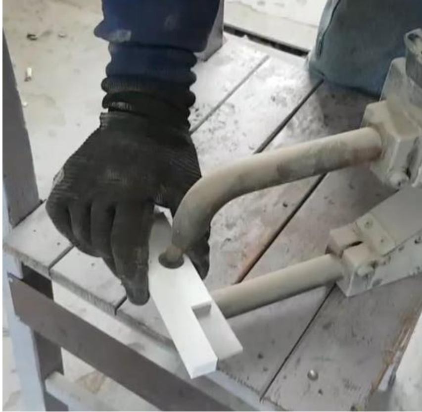
Şekil 6.1 Kaynak işlemi için tasarlanan aparat ve kaynak işleminin yapılışı.
