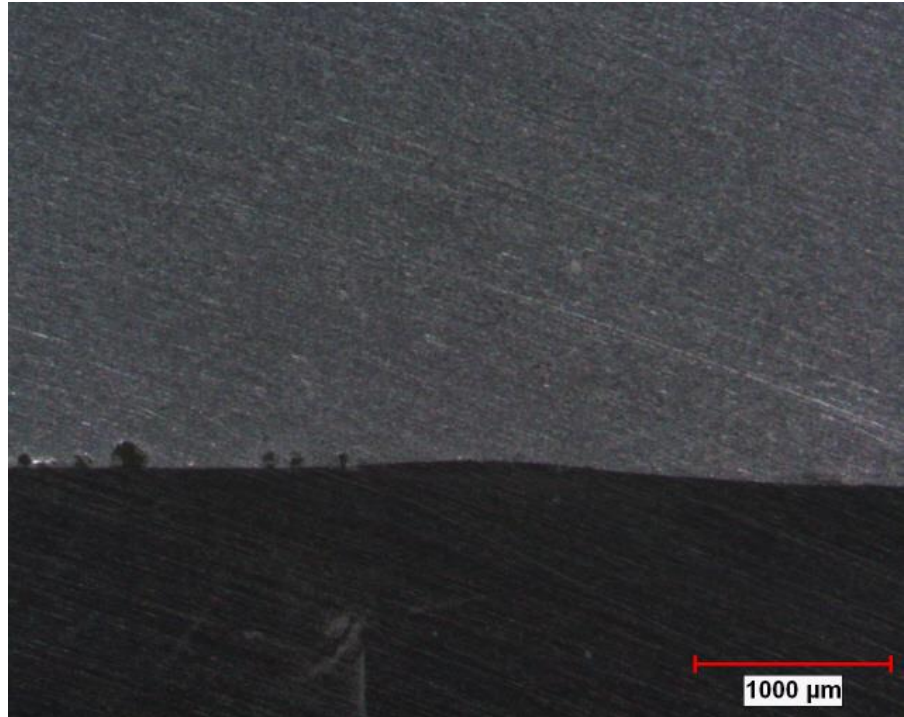
Şekil 7.9 Korozyon testi öncesi AISI 304 – AA5083 malzeme çiftinin 20X büyütmede çekilmiş makroyapı görüntüsü.
