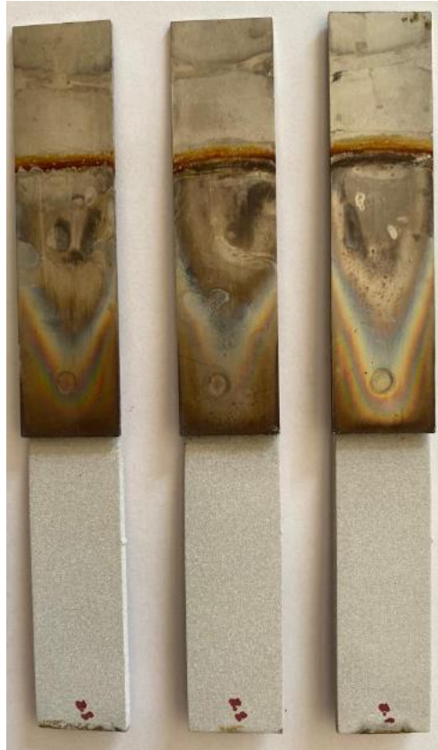
Şekil 7.3 AA5083- AISI 304L (7 kA) numunelerinin korozyon testi sonrası ön yüz görüntüleri.
