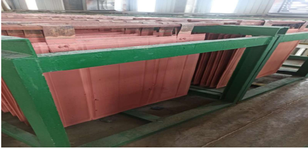
Şekil 2.3: Bakırın elektrolitik rafinasyon işlemi sonrası katot levha hali
