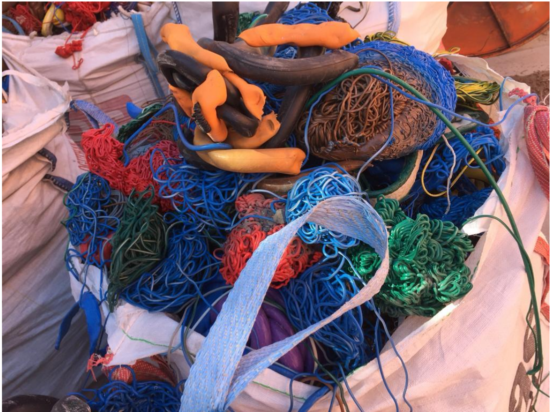
Şekil 3.7: Kablo üretiminde oluşan plastik atık
