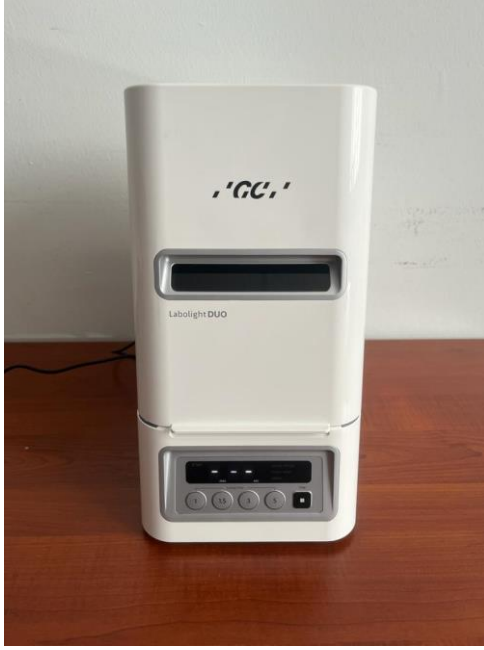
Şekil 3.4. Labolight DUO polimerizasyon cihazı
