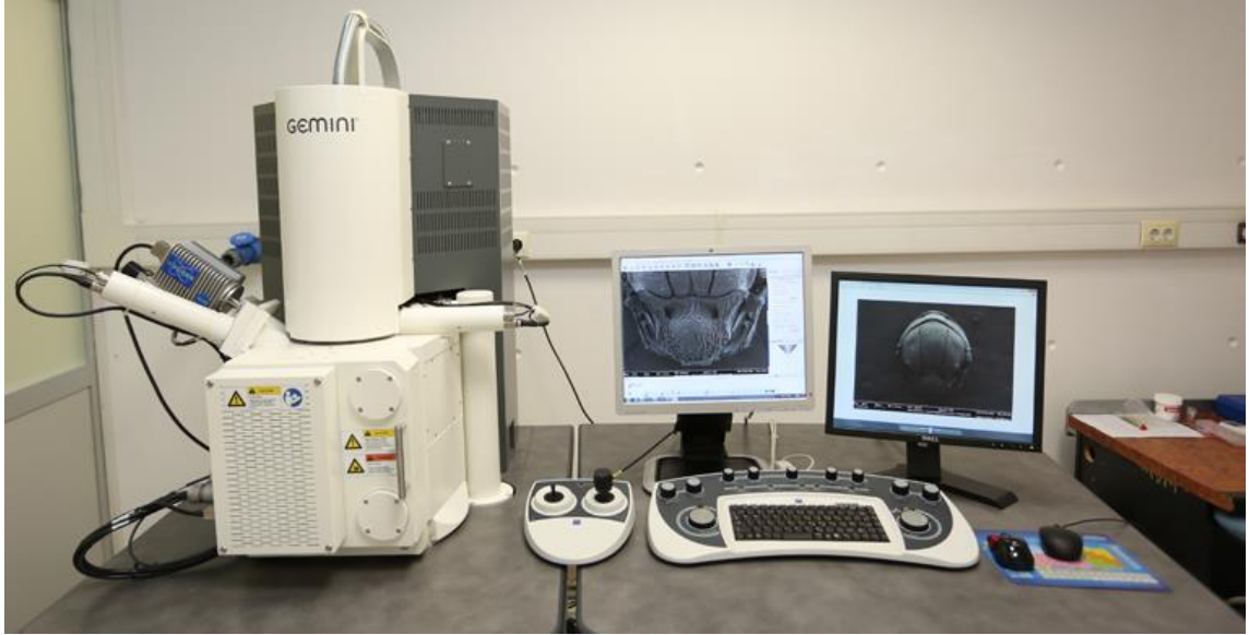
Şekil 3.20. Örnekleri görüntülemek için kullanılan SEM cihazı
