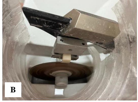
Şekil 3.6. A. Struers Minitom hassas kesim cihazı B. Su soğutması altında kesilen CAD/CAM blok
