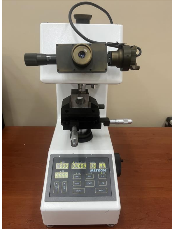
Şekil 3.19. Mikrosertlik ölçüm cihazı
