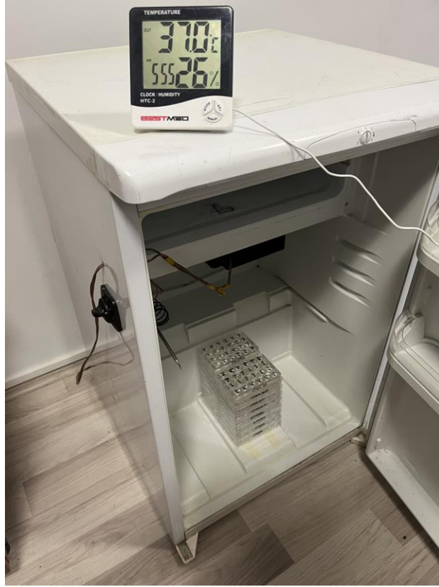
Şekil 3.13. Etüv içerisine yerleştirilmiş örnekler
