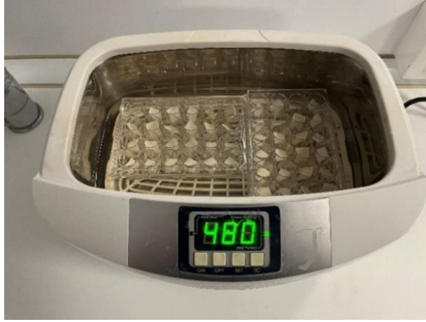
Şekil 3.11. Ultrasonik temizleme cihazında örneklerin temizlenmesi
