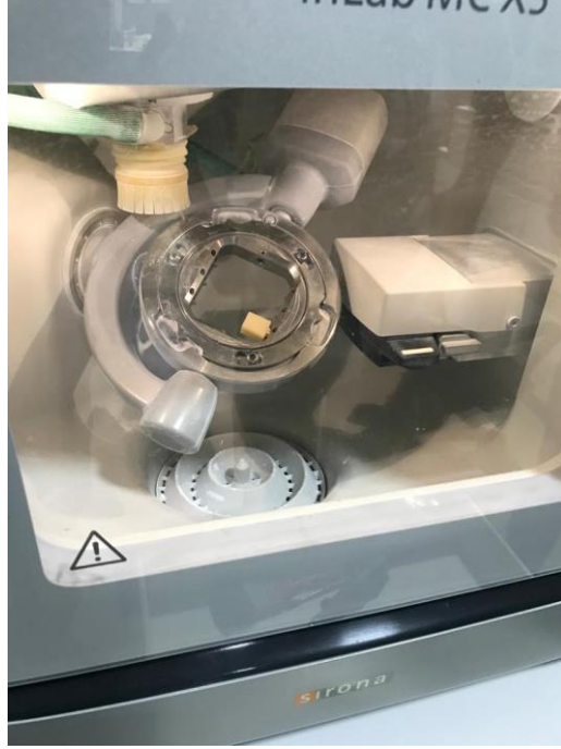
Şekil 3.7. DMA analizi için örneklerin kazınması
