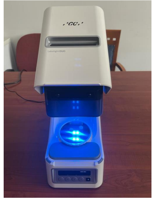
Şekil 3.4. Labolight DUO polimerizasyon cihazı
