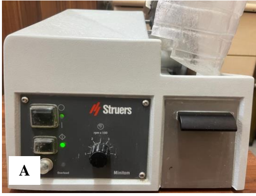
Şekil 3.6. A. Struers Minitom hassas kesim cihazı B. Su soğutması altında kesilen CAD/CAM blok
