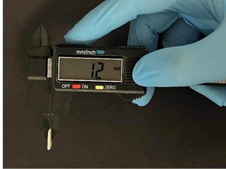
Şekil 3.10. Dijital kumpas ile kalınlık ölçümü
