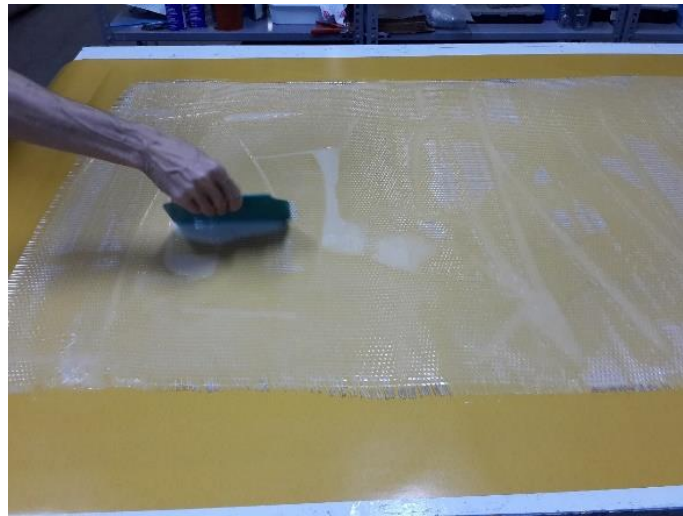
Şekil 2.6: Kumaşa reçine emdirme işlemi.
