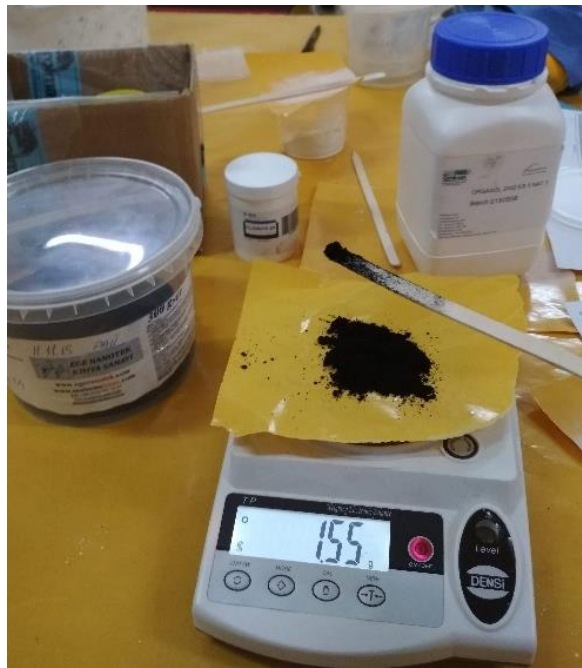
Şekil 2.4: Katkı maddelerinin hassas terazi ile tartılması.
