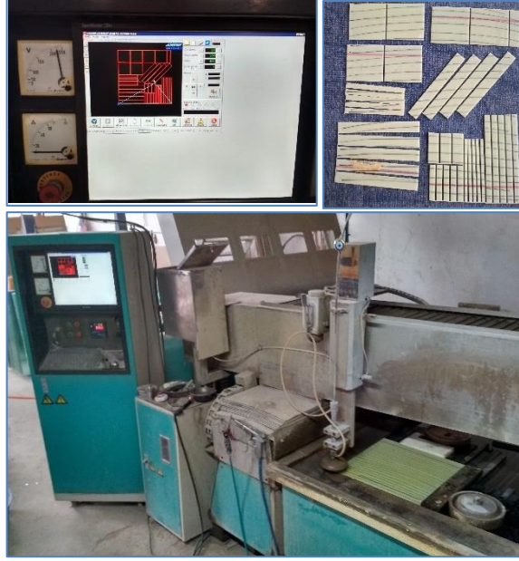
Şekil 2.10: Su jeti ile numune boyutlarına kesme.
