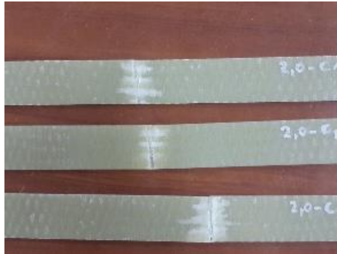
Şekil 3.2: Çekme deneyi yapılmış %2 nanokil katkılı numune örneği.
