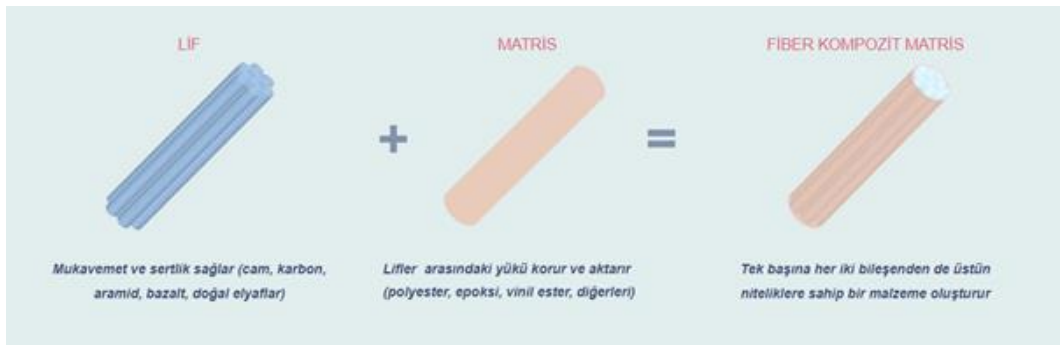
Şekil 1.1: Kompoziti oluşturan ana öğeler (Acma, 2016).
