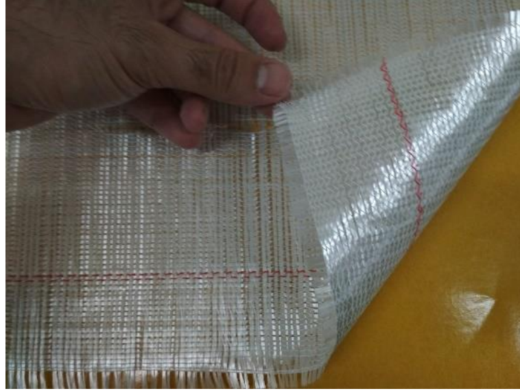
Şekil 2.3: Takviye malzemesi 0°/90° kıvrımsız dikişli cam elyaf kumaş.
