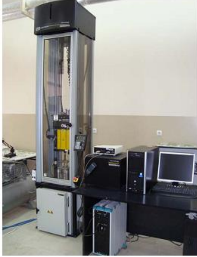
Şekil 2.13: Instron-Dynatup 9250 HV darbe deneyi cihazı.
