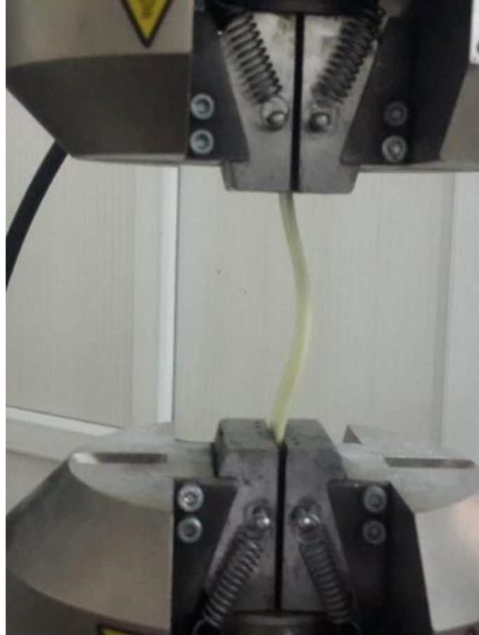
Şekil 3.13: Burkulma deneyi uygulanmış numune örneği.
