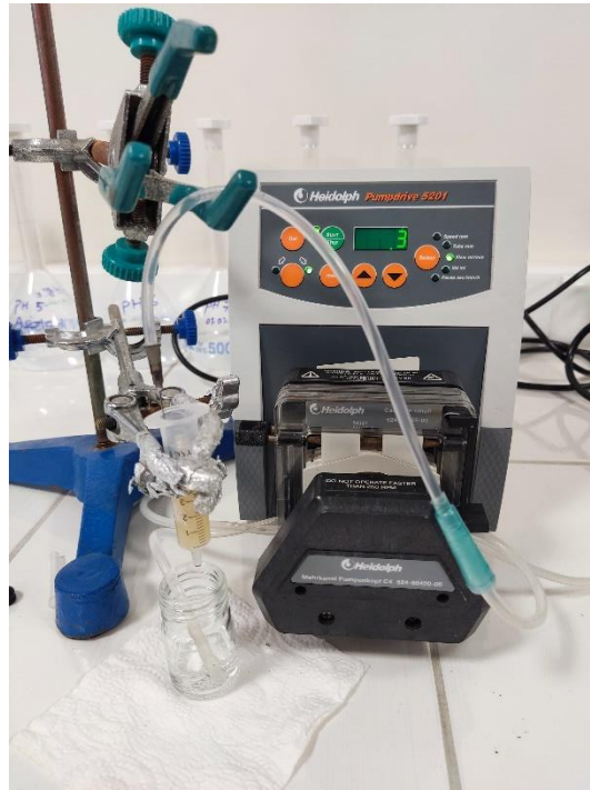
Şekil 5.1: Adsorpsiyon çalışmalarının yürütüldüğü peristaltik pompalı sürekli sistem
