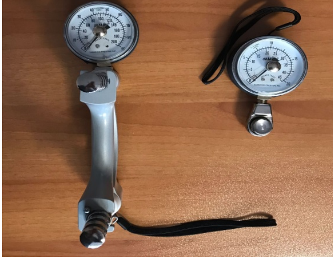
Şekil 7. Jamar hidrolik el dinamometresi
