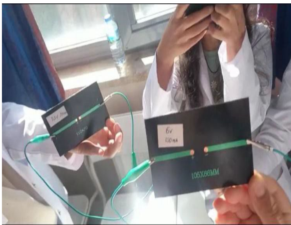
Şekil 3.11. Hazır panellerin seri bağlanması
