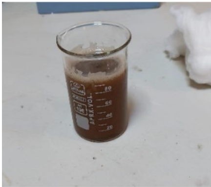
Şekil 3.35. Fiziksel arıtım için hazırlanan çamurlu su
