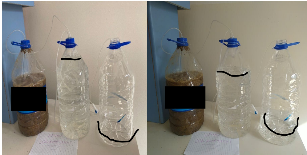
Şekil 3.41. Hayvan gübresi biyokütle kaynağı kullanılarak oluşturulan farklı bir sistemin bir hafta sonraki değişimi
