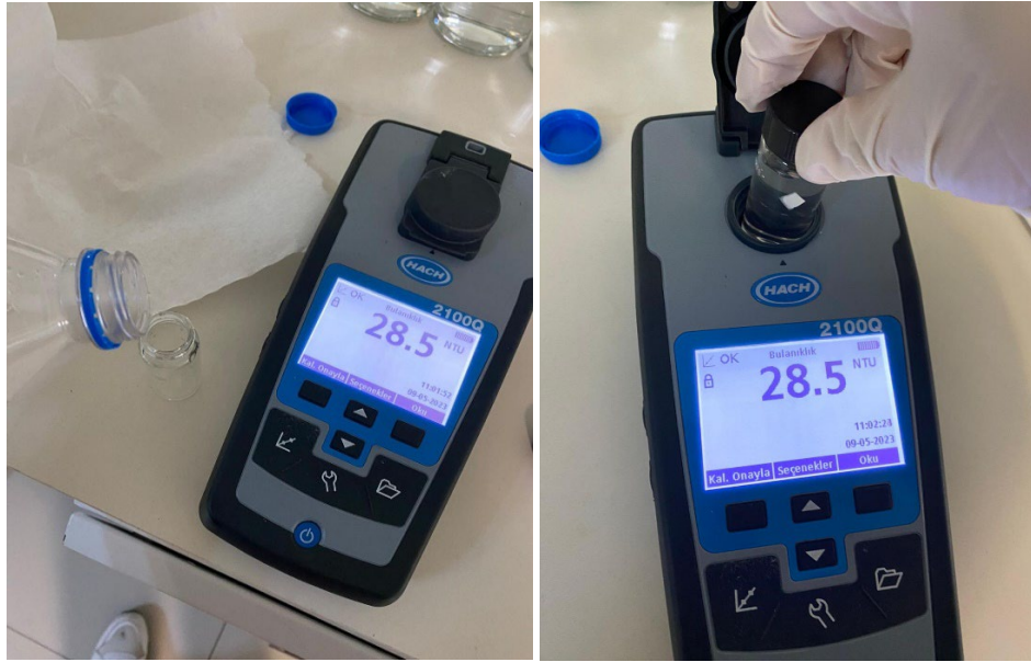
Şekil 3.36. Türbidimetre bulanıklık cihazı ile ölçümlerin yapılması
