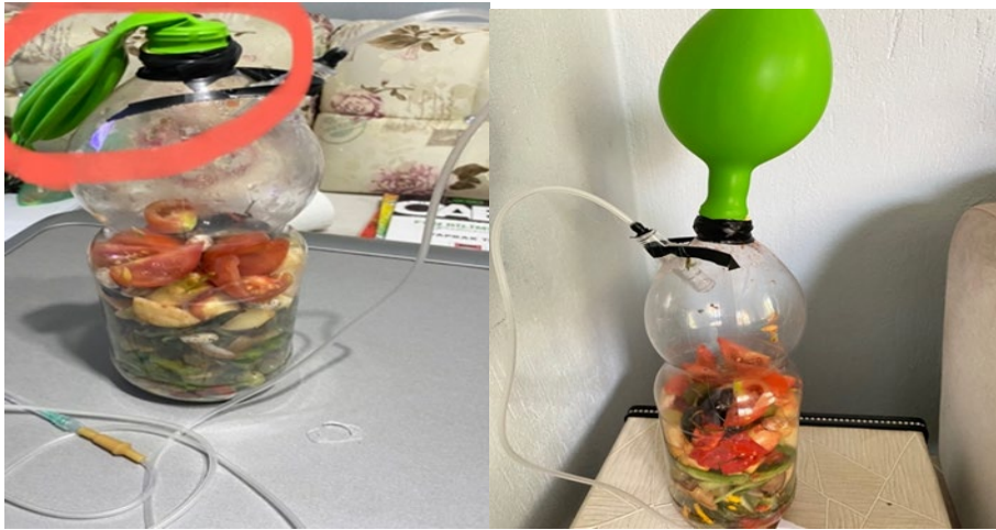
Şekil 3.39. Meyve ve sebzelerin biyokütle kaynağı olarak kullanıldığı bir sistemde bir hafta sonunda balonun şişmesi
