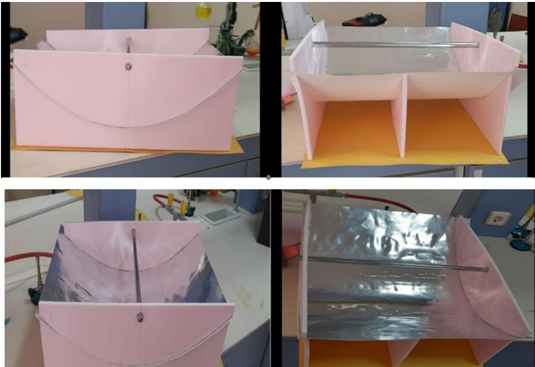
Şekil 3.17. Parabolik güneş kolektörü prototipi yapım fotoğrafları
