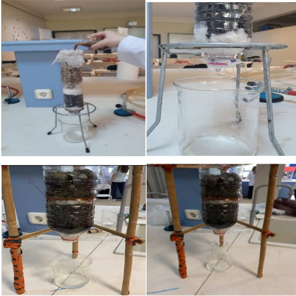
Şekil 3.34. Yağmur suyu fiziksel arıtım prototipi örnekleri (öğrenci çalışmaları)
